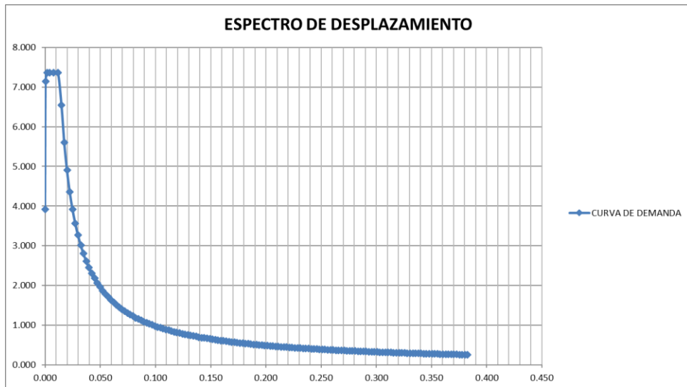
Figura 55: Espectro Sísmico de desplazamiento
