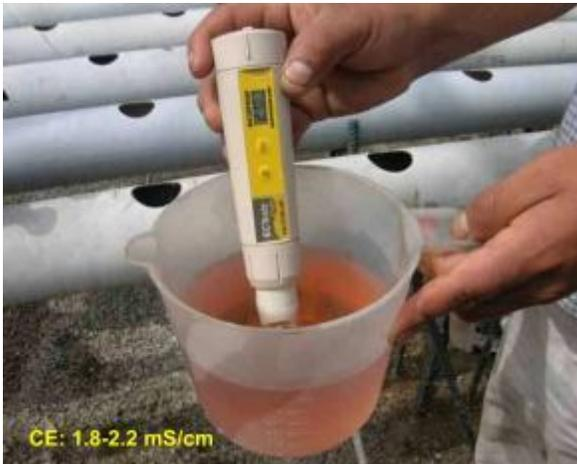
Figura 9 : Medición del nivel de CE mediante
