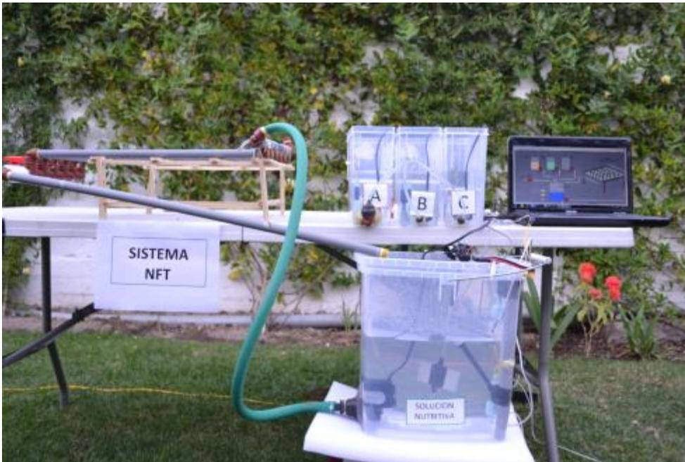
Figura 100 : Maqueta del Sistema NFT para el proceso de Control y Automatización
