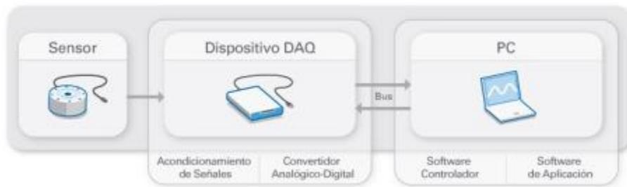
Figura 30: Partes de un sistema DAQ [11]
