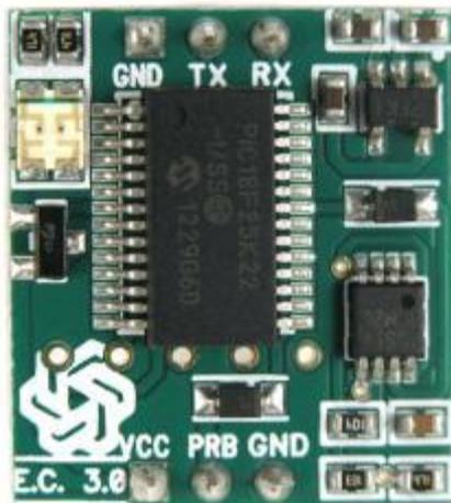
Figura 58 : Circuito del Sensor de C.E.
