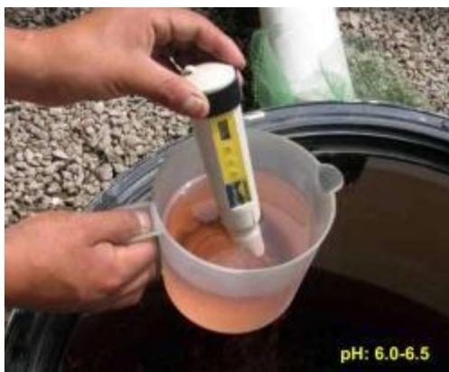
Figura 8 : Medición del nivel de pH mediante
