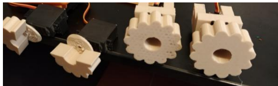
Figura 97. Actuadores con sus mecanismos de frotamiento Fuente: elaboración propia
