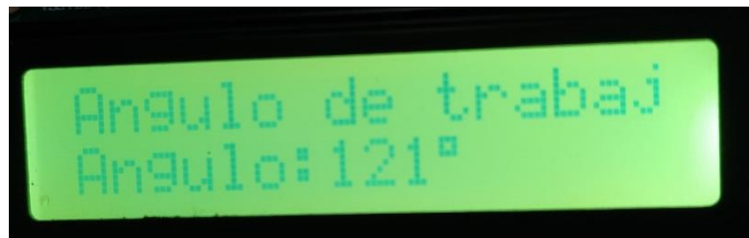
Figura 136. Exoesqueleto en 120° con error de \pm 2^\circ , marcando 121° Fuente: elaboración propia
