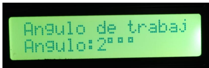
Figura 134. Exoesqueleto en 0^\circ con error de \pm 2^\circ , marcando 2^\circ Fuente: elaboración propia
