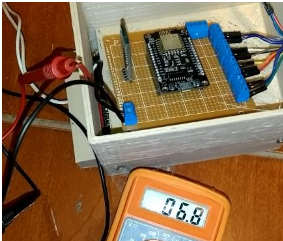
Figura 131. Medición en multímetro de corriente consumida por el exoesqueleto Fuente: elaboración propia
