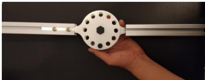
Figura 94. Perfil de aluminio con pieza para giro del exoesqueleto Fuente: elaboración propia
