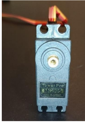
Figura 108. Servo MG995 Fuente: elaboración propia
