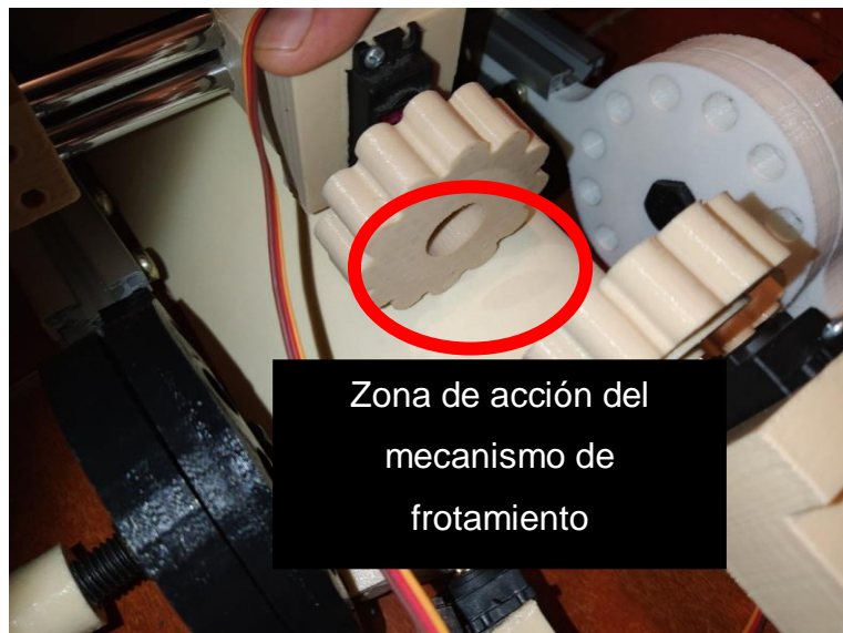
Figura 132. Capas de etilvinilacetato en contacto con el mecanismo de frotamiento Fuente: elaboración propia
