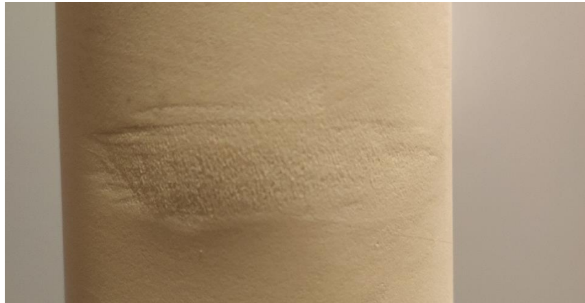
Figura 133. Desgaste del etilvinilacetato Fuente: elaboración propia
