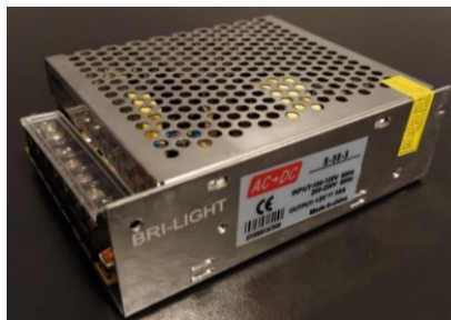
Figura 112. Fuente de alimentación de 5V y 10 Amperios Fuente: elaboración propia
