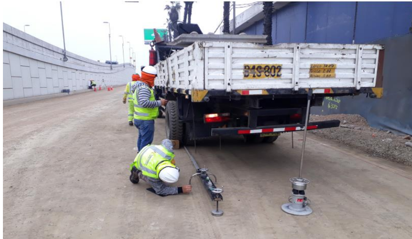
Figura 11: Equipos Light Falling Weight Deflectometer (LWD) y Viga Benkelman (VB) de brazo simple para recolección de datos de deflexión y módulos resilientes Fuente y Elaboración: Propia
