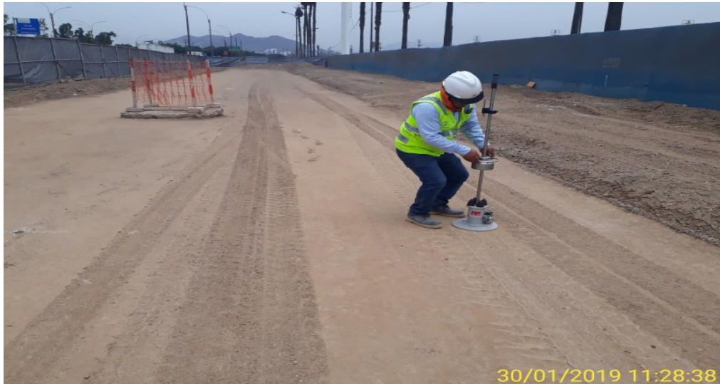
Figura 28: Ensayos con el equipo Light Falling Weight Deflectometer a diferentes aplicaciones de carga en una capa conformada.
