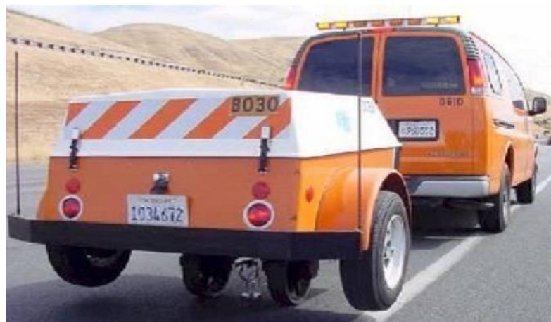
Figura 02: Equipo para realización del ensayo de deflexión –Dynaflect Fuente: Dynatest
