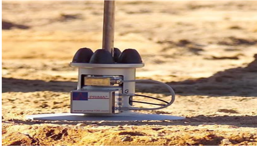
Figura 04: Equipo Light Falling Weight Deflectometer - PRIMA 100 Fuente: Manual del usuario Deflectómetro de impacto liviano (LWD)
