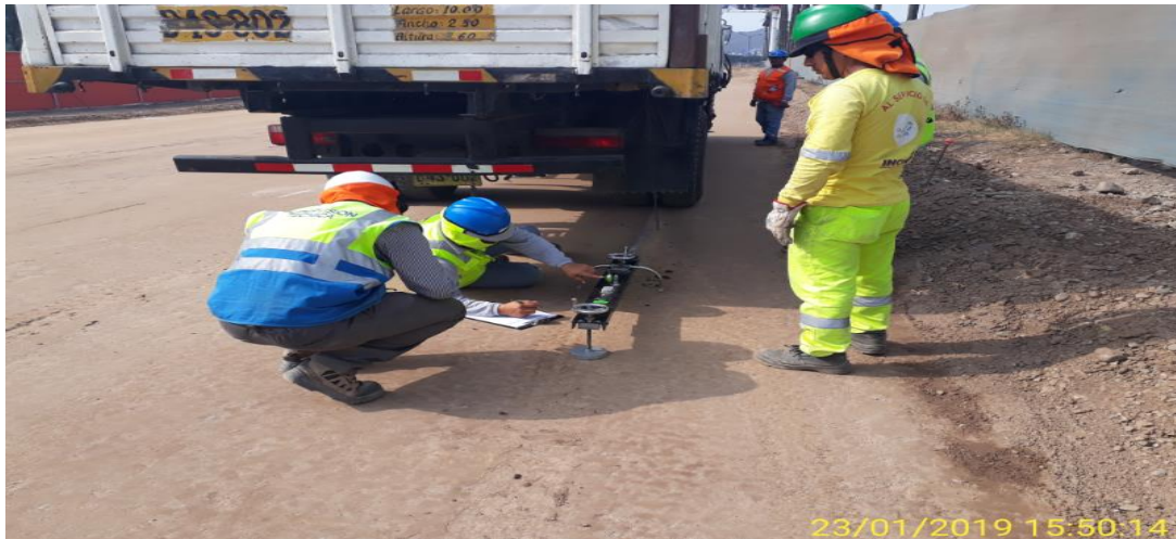
Figura 26: Ensayos en campo con el equipo Viga Benkelman en una capa conformada. Fuente: Propia.
