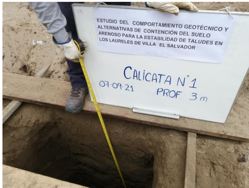
Figura 37: Calicata 1 Fuente: Propia (2021)
