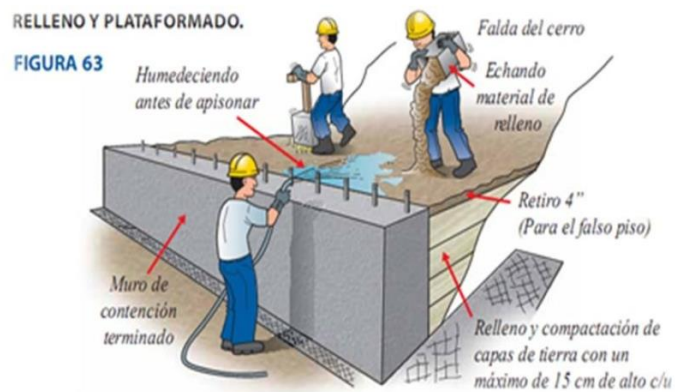
Figura 21:Desencofrado, relleno y plataformado del muro de contención
