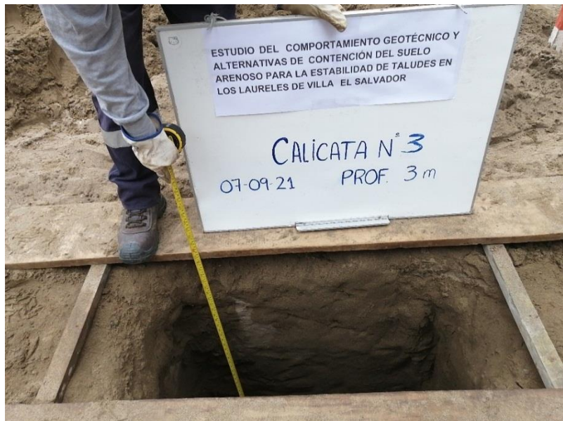
Figura 38: Calicata 3 Fuente: Propia (2021)
