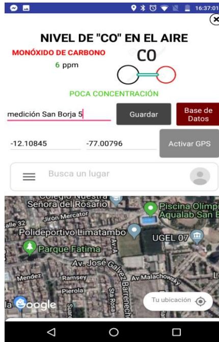
Figura N° 26 : Captura de la medición realizada en San Borja. Medida más GPS
