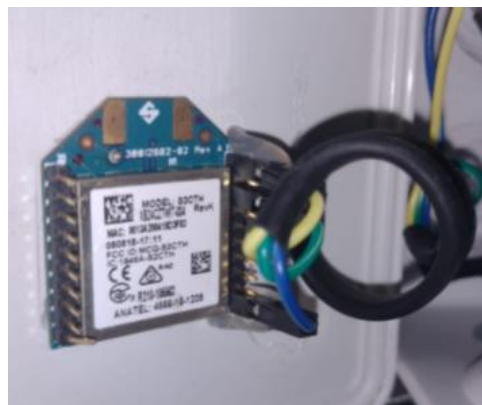
Figura N° 5: Módulo XBee Transmisión con protocolo de Comunicación Zigbee
