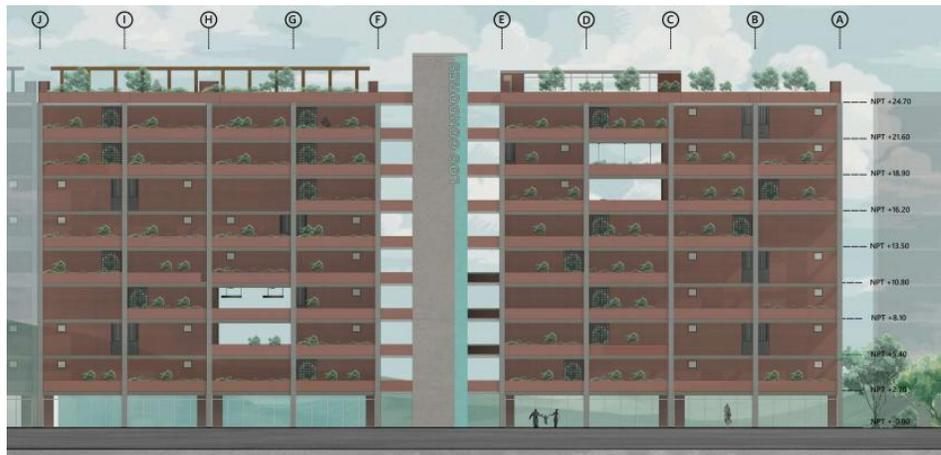
FIGURA 116: Elevación Fachada Posterior Torre tipo B
