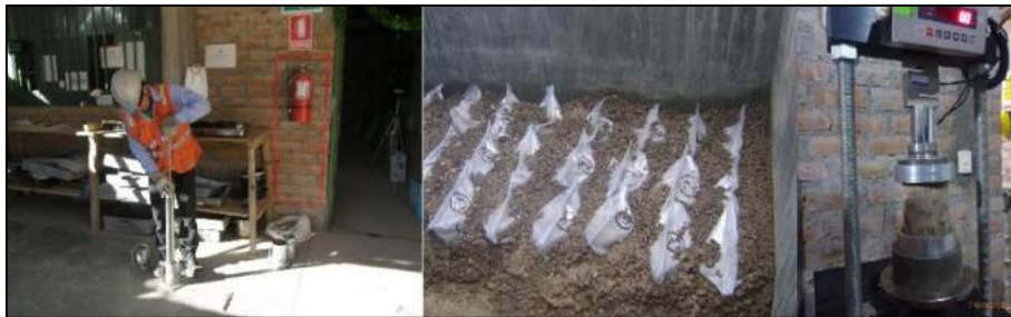
Figura 4.30 – Remoldeo, curado y rotura de probetas suelo – cemento
