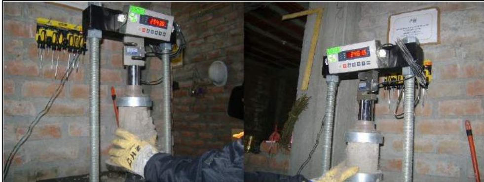
Figura 4.19 – Ensayos de compresión no confinada
