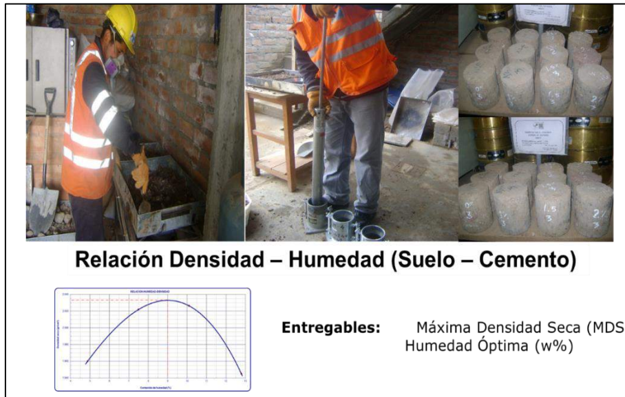
Figura 4.17 – Conformación de probetas de suelo – cemento
