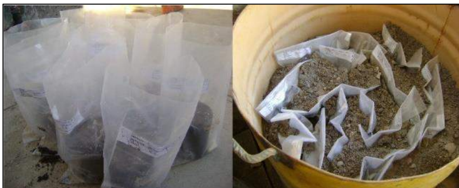
Figura 4.18 – Curado de probetas de suelo – cemento
