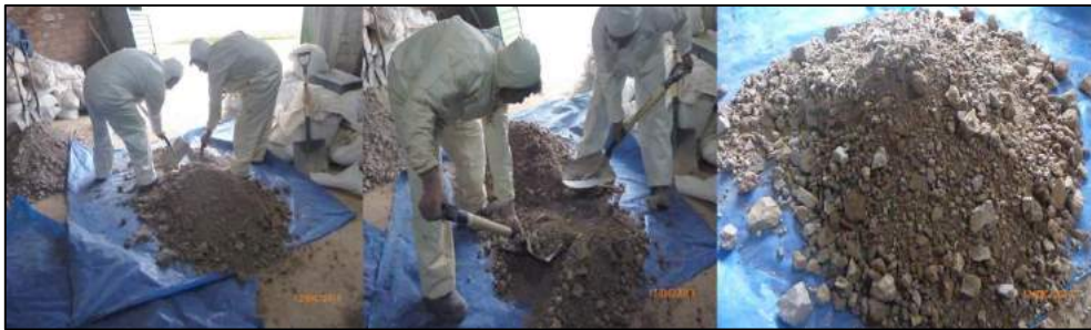
Figura 4.15 – Mezcla de suelos para diseño base suelo – cemento
