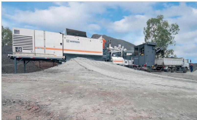
*Nota:* en el reciclado en frío en planta el material es llevado hasta una planta móvil, como la que se puede ver en la imagen, y se estabiliza con asfalto espumado y, en caso fuera necesario, cemento y agua para lograr una mezcla homogénea y en óptimas condiciones para su puesta en obra. Extraído de (Wirtgen, 2019).
