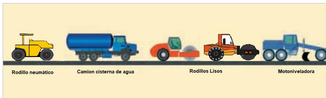
*Nota:* el tren de perfilado y compactado se compone de una motoniveladora y los rodillos lisos, para seguidamente dar paso a la cisterna de agua y al rodillo neumático. El agua se agrega con el fin de densificar un poco más el material y que las densidades suban al 100%. Adaptación propia.
