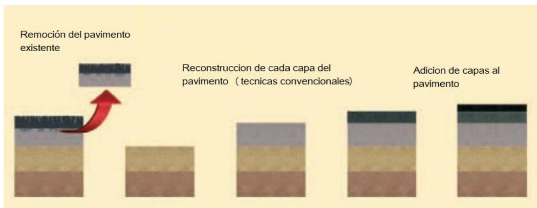
Nota: el proceso de reconstrucción del pavimento puede ir de la mano con proyectos de mejora que exige cambios en la alineación de la vía. Adicionalmente, se pueden agregar capas extras a las ya existentes con la finalidad de proveer más resistencia. Extraído de (Wirtgen, 2012, p. 35).
