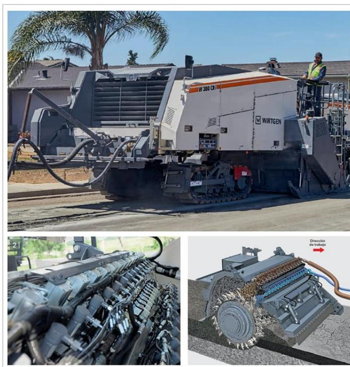
*Nota:* en la figura se aprecia la recicladora Wirtgen y sus componentes como son los ductos por los que el asfalto espumado llega hasta la cámara de mezclado y se mezcla con el material recuperado del pavimento existente. Adaptado de Wirtgen, 2019.
