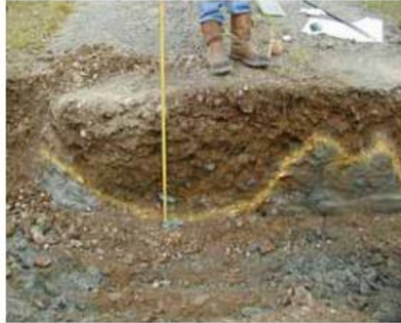
Figura 4. Un caso avanzado de ahuellamiento Modo 2 visto en un pavimento exhumado con una subrasante muy débil
