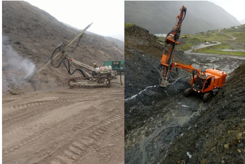
Figura N° 12: Equipos de perforación con martillo de cabeza Neumática (izquierda), Hidráulica (derecha)
