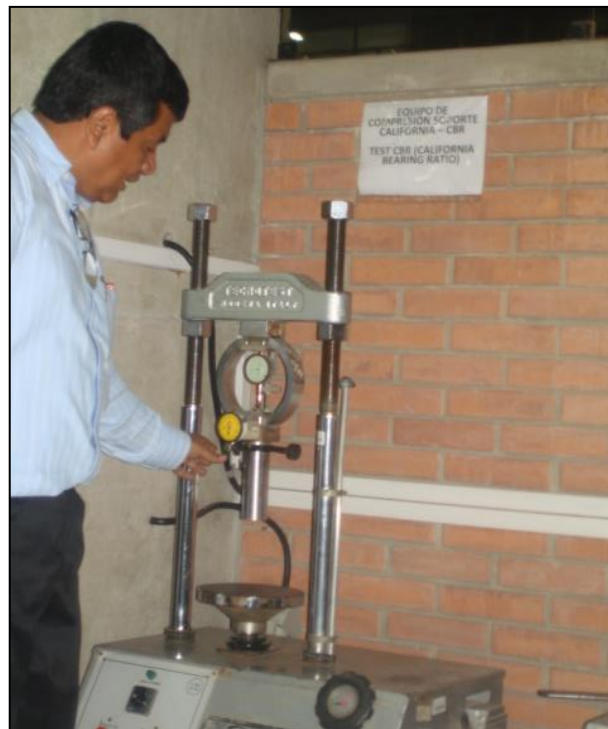
Figura N°45: Equipo de compresión de soporte California CBR
