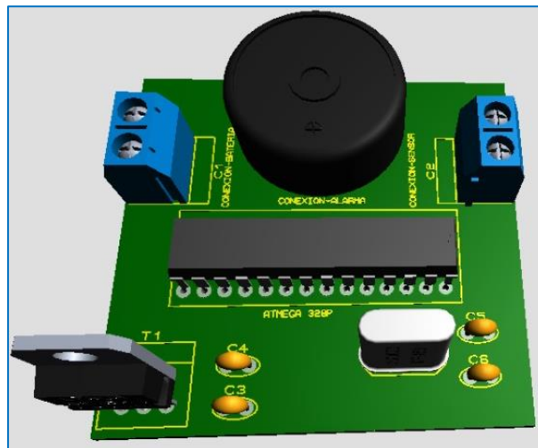
Figura 53. Placa electrónica diseñada en el software Proteus 60
