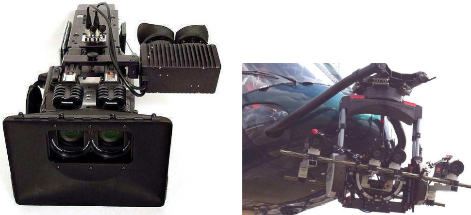
FIGURE 5. Exemple de systèmes d'acquisition binoculaire basés image : (a) rig rigide ; (b) rig robotisé hélicoptère utilisé par Binocle pour le film "La France entre ciel et mer".
