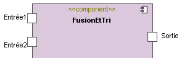
Figure 4.3- Vue externe d'un composant FusionEtTri .
