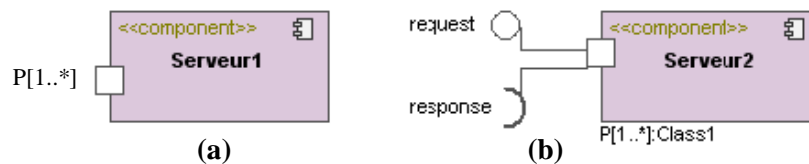
Figure 4.2- Représentation d'un port avec ou sans interfaces.
