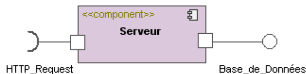
Figure 4.1- Représentation d'un composant doté de deux interfaces.
