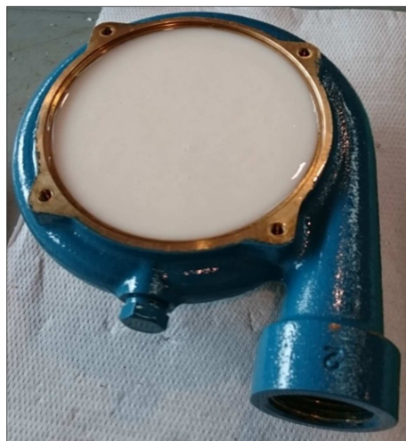
Figura 4.1 Voluta della pompa dopo la colata di gomma
