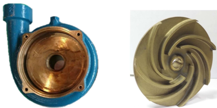
Figura 3.1 Pompa 1: voluta e girante
