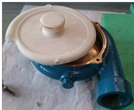
Figura 4.2 Forma in silicone solidificato estratto dalla voluta
