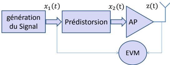
FIGURE 1 – Diagramme de bloc de chaîne de transmission
