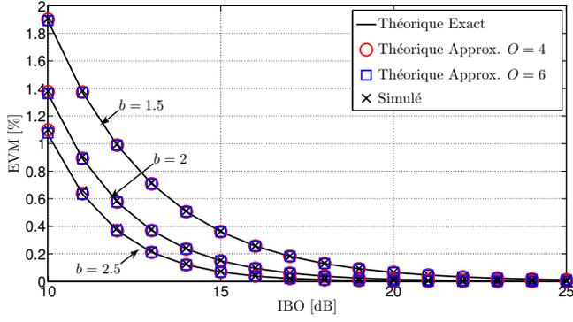
FIGURE 2 – EVM exacte, approximée et simulée d'un signal OFDM sans prédistorsion
