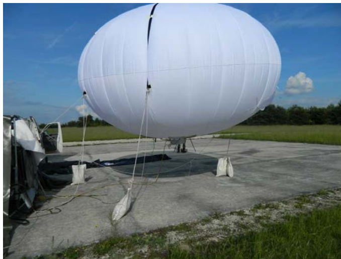
FIGURE 3.23 – Ballon gonflé à l’hélium maintenu par des lests.
