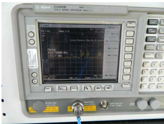
(e) Spectre reçu par une antenne seule
