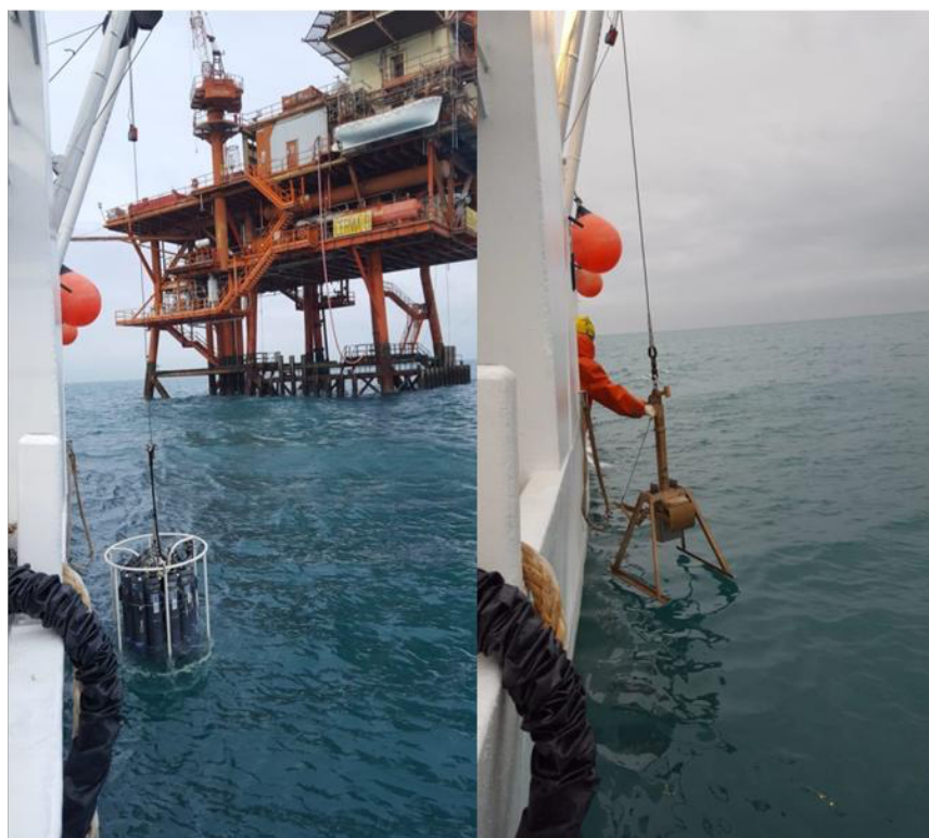
Fig. 4: Sonda multiparametrica CTD su un frame di 12 bottiglie Niskin (a sinistra), box-corer per il campionamento dei sedimenti (a destra).
