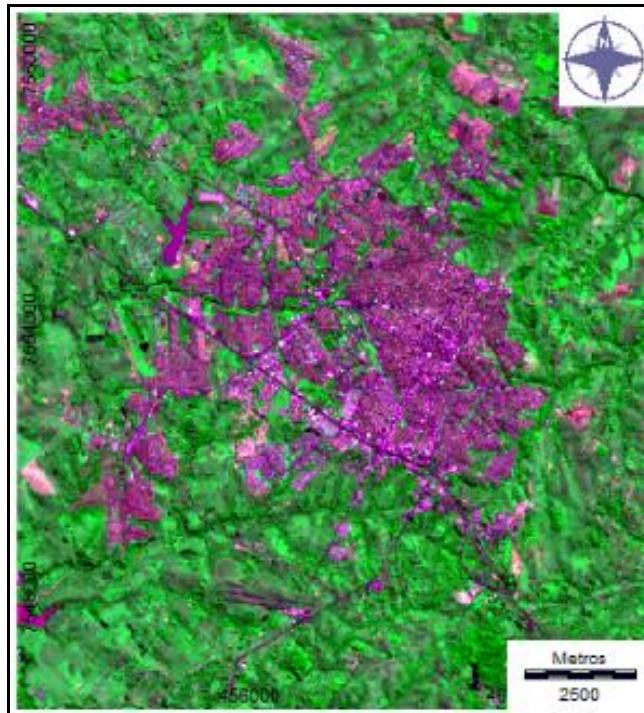
Figura 1 - Composição colorida de Presidente Prudente (SP), elaborada a partir das bandas 3, 5 e 4 da imagem Landsat 8, 24/08/2014.
