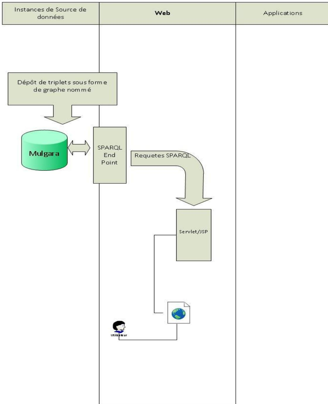
Figure 8 : Architecture réalisée dans la preuve de concept
