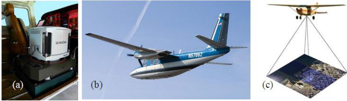
Rajah 1.1 (a) Kamera udara di dalam pesawat udara berpemandu, (b) Pesawat udara berpemandu yang digunakan untuk perolehan imej, (c) Perolehan imej (Kimball, 2011)
