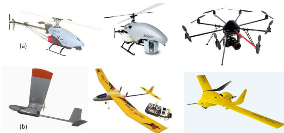
Rajah 1.2 Contoh Pesawat Tanpa Pemandu (UAV) di pasaran untuk kegunaan awam dengan rekabentuk berbeza. (a) Kepak Rotor (b) Kepak Kaku
