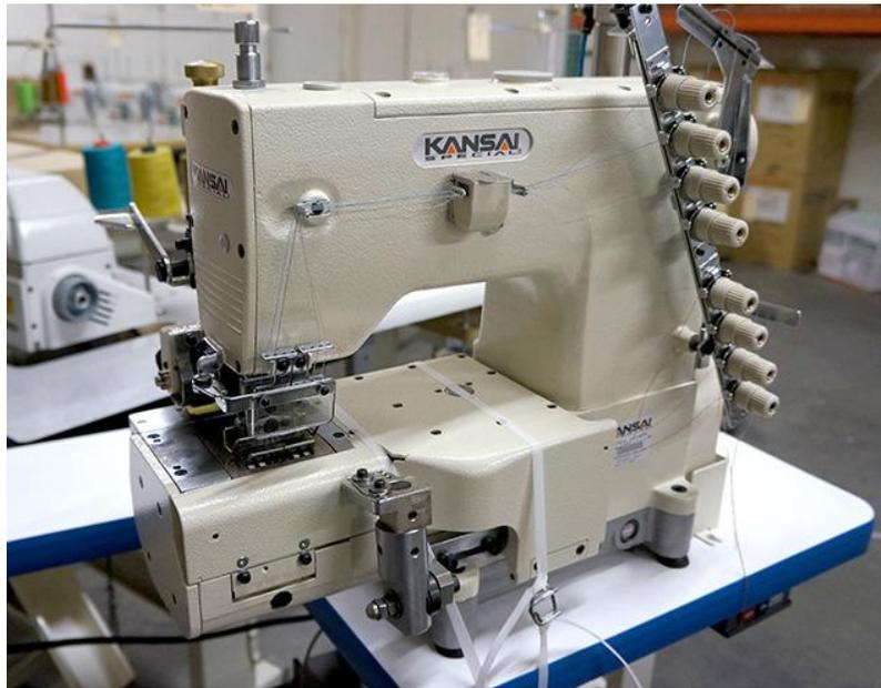
La Máquina Multi-Special es utilizada para ensamblar y hacer costuras al elástico utilizado en la cintura de los pants y calzonetas así como otros detalles que se puedan agregar a las prendas.
