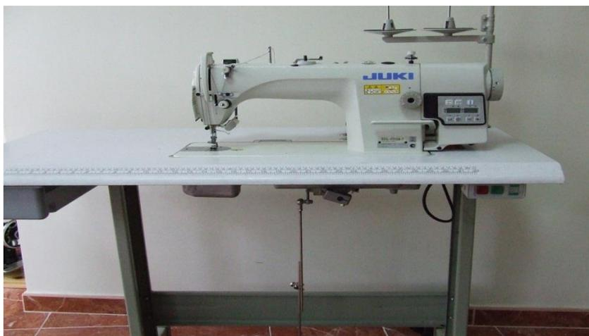
La máquina plana es utilizada para hacer costuras de forma recta, es más que todo para hacer ensamble de piezas que no necesiten una costura con mucho refuerzo además de ser utilizada para dar retoques a las prendas de vestir como el ensamble de bolsas.
