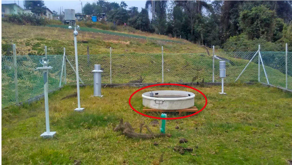
Figura 18. Tanque evaporímetro clase A
