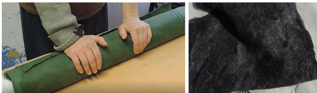
Bilde 3. Filtduken ble rullet inn på en rull og «knadd» på begge sider (t.v.). Ferdig filtet duk (t.h.).
