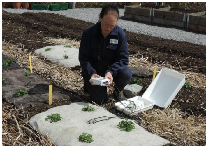
Bilde 6. Utlegging av temperatur- og fuktighetslogger i forsøksrutene. Foto: Hanne Iren Dahlen
