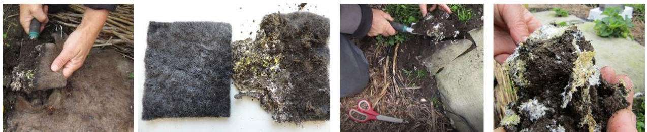
Bilde 11. Et hjørne av ulldukene ble klippet av 29. juni. De to bildene til venstre viser filtet duk som sammenlignes med ubrukt duk. De to bildene til høyre viser vevd duk under nedbryting. Foto: Solveig Johnsen
