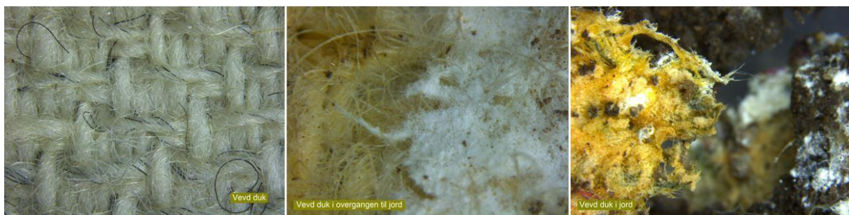
Bilde 14. Vevd duk under mikroskop 29. juni. T.v. ubrukt duk, i midten overgangen mellom duk og jord, t.h. duk i jord.
