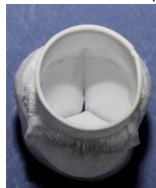
Abbildung 1: Elektrosponnener Herzklappenscaffold aus Polycaprolacton
