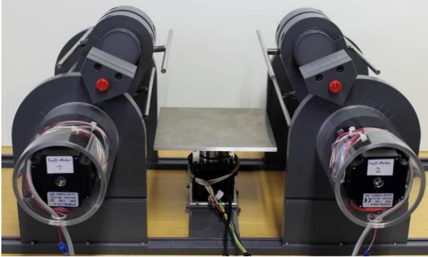
Abbildung 3: Translationskollektor (Troll) zur Erzeugung von orientierten Faserverbundstrukturen
