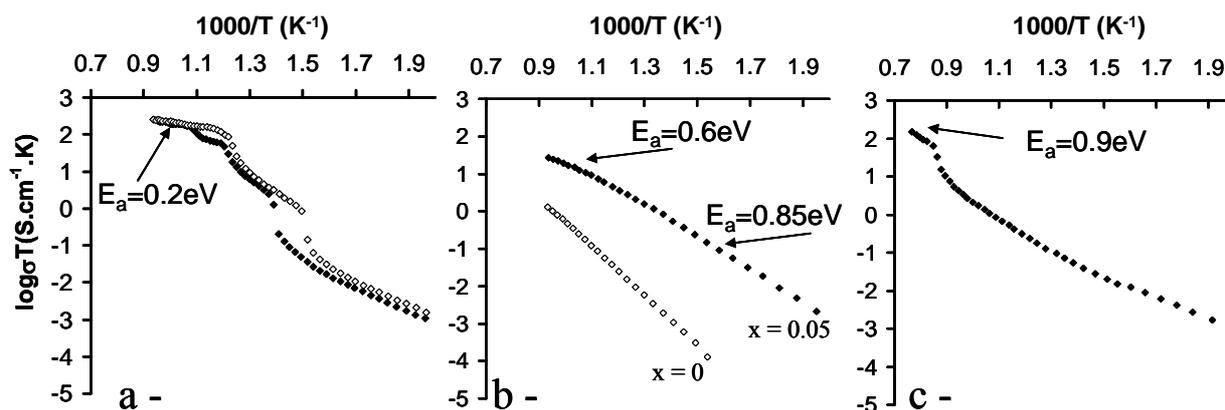
Figure 2. Conductivité de  $\text{Bi}_4\text{V}_2\text{O}_{11}$ ,  $\text{Bi}_2\text{WO}_6$  substitué et  $\text{Ba}_2\text{In}_2\text{O}_5$  en fonction de la température
