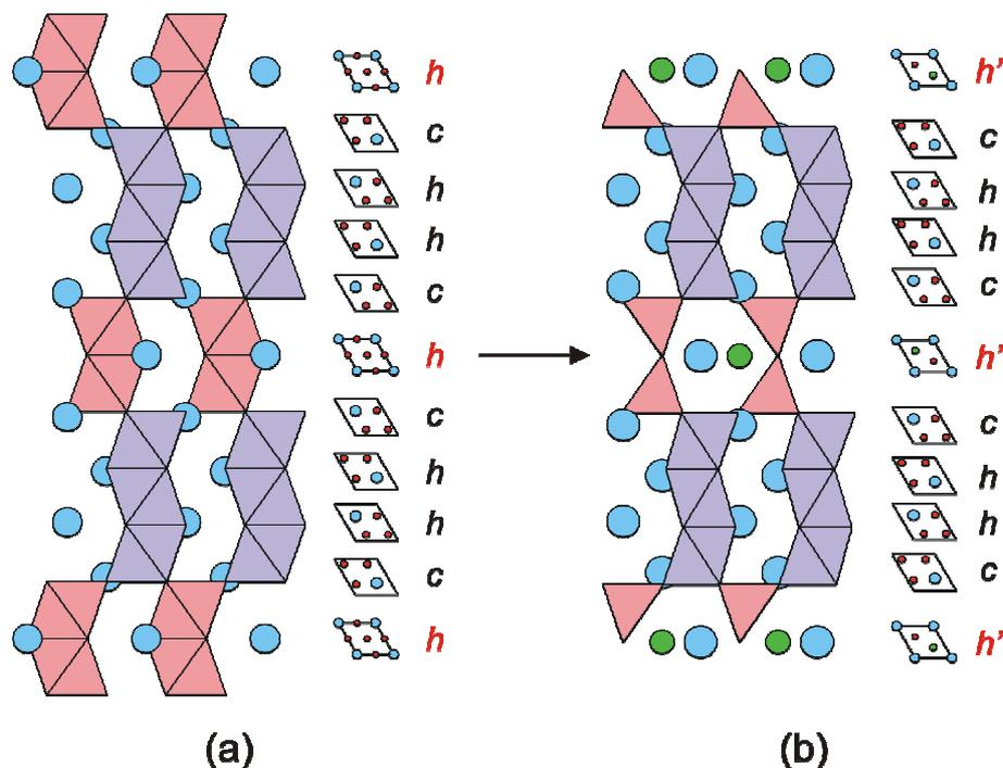
**Figure 1.10 :** Structures 10H des cobaltites (a)  $\text{BaIr}_{0.3}\text{Co}_{0.7}\text{O}_{2.83}$  et (b)  $\text{Ba}_5\text{Co}_5\text{ClO}_{13}$ . La substitution d'une couche  $[\text{BaO}_3]$  par une couche  $[\text{BaOCl}]$  transforme les dimères  $\text{Co}_2\text{O}_9$  en dimères  $\text{Co}_2\text{O}_7$
