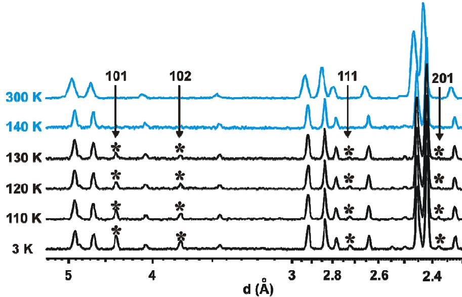
Figure 3.2 : Diffractogrammes de neutrons isothermes du composé  $Ba_6Co_6ClO_{15,5}$
