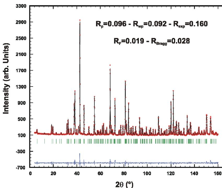
Figure 2.3 : Facteurs d'accord et superposition des diffractogrammes observé (...) et calculé (—) du composé  $Ba_6Co_6ClO_{15,5}$  (données de diffraction des neutrons collectées à température ambiante)
