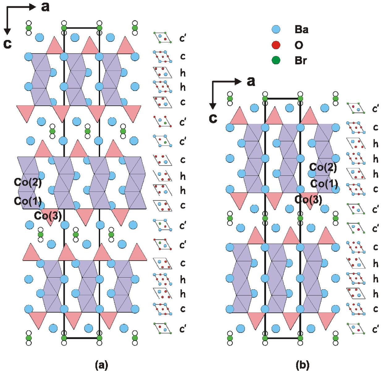
Figure 2.19 : Représentation des structures de (a) 18R-Ba<sub>6</sub>Co<sub>5</sub>BrO<sub>14</sub> et (b) 14H-Ba<sub>7</sub>Co<sub>6</sub>BrO<sub>17</sub>, vues selon la direction (010). Par souci de clarté, les désordres structuraux observés sur les atomes d'oxygène et de brome des doubles couches [Ba<sub>2</sub>O<sub>2</sub>Br] n'ont pas été représentés
