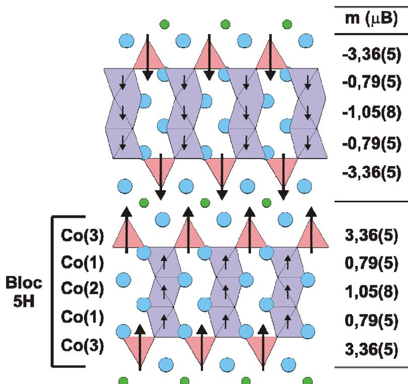
*Figure 3.22 : Représentation de la structure magnétique à 1,4 K de  $\text{Ba}_6\text{Co}_5\text{BrO}_{14}$  en l'absence de champ magnétique. Le tableau présente les valeurs des moments magnétiques portés par chaque atome de cobalt*
