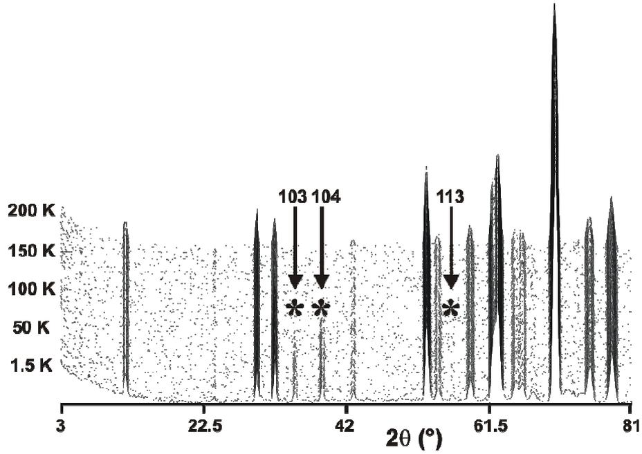
*Figure 3.5 : Thermodiffractogrammes de neutrons du composé  $Ba_5Co_5ClO_{13}$*
