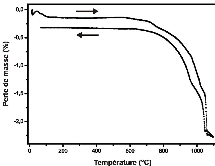
Figure 2.9 : Analyse thermogravimétrique du composé  $Ba_6Co_6ClO_{15,5}$  sous air
