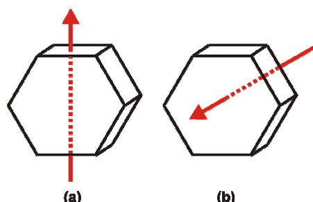
**Figure 3.26 : Orientation du moment net (flèche rouge) dans une cristallite en forme de plaquette hexagonale – (a) moment dans le plan  $ab$  (structure avec angle de *canting*) et (b) moment parallèle à  $c$  (structure ferrimagnétique)**
