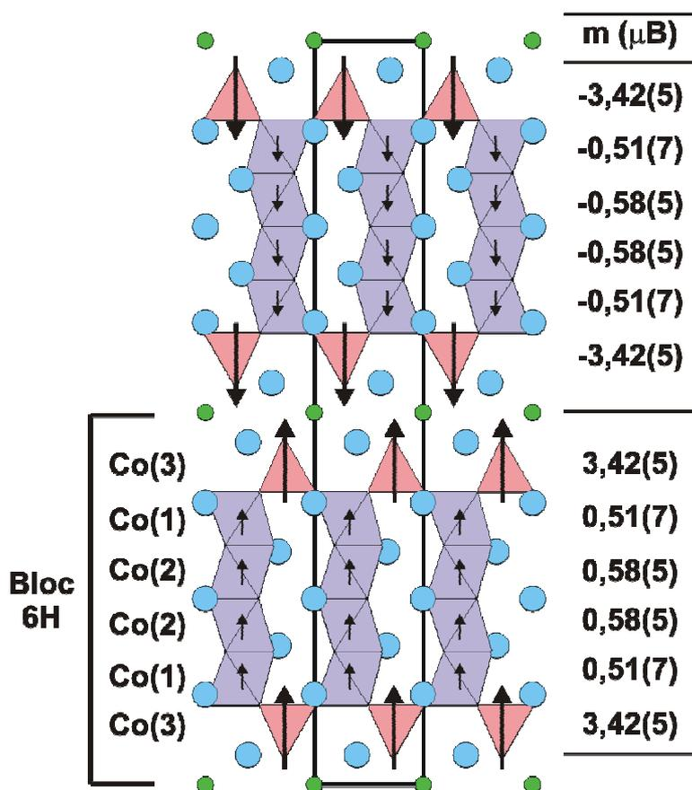
*Figure 3.18 : Représentation de la structure magnétique à 1,4 K de  $\text{Ba}_7\text{Co}_6\text{BrO}_{16,5}$  sans champ magnétique. Le tableau présente les valeurs des moments magnétiques portés par chaque atome de cobalt*
