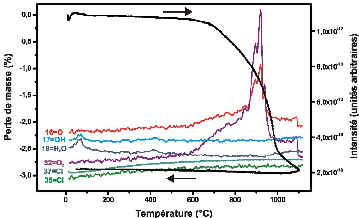
Figure 2.5 : Analyse thermogravimétrique et spectrométrie de masse du composé Ba<sub>6</sub>Co<sub>6</sub>ClO<sub>15,5</sub> sous atmosphère inerte (argon)
