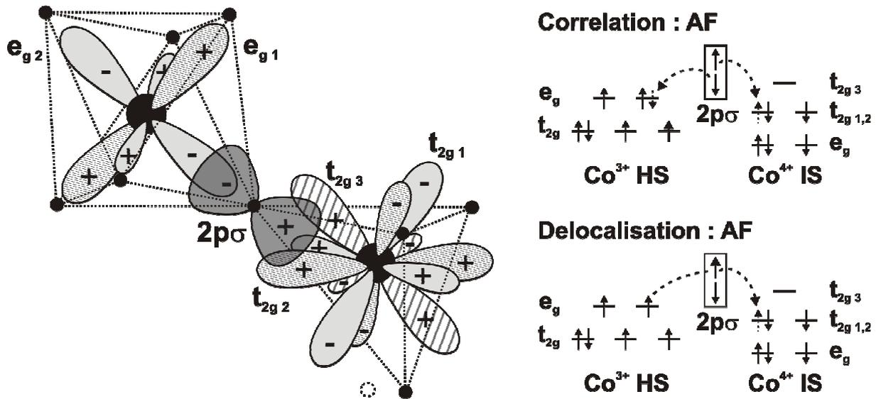
*Figure 4.4 : (a) orientation des orbitales  $t_{2g}$  de Co(1),  $p\sigma$  de O et  $e_g$  de Co(3) participant à la jonction octaèdre tétraèdre et mécanismes de transfert des électrons par corrélation ou par délocalisation*
