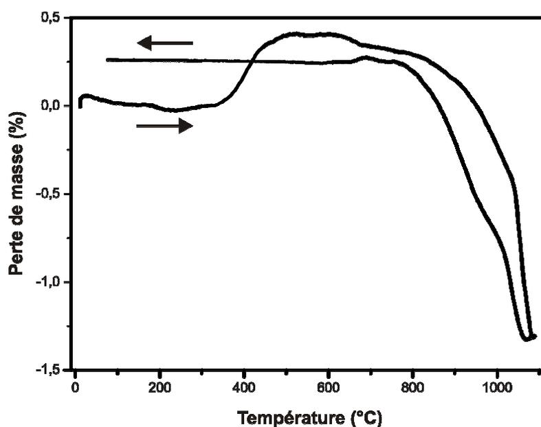
Figure 2.15 : Analyse thermogravimétrique du composé  $Ba_5Co_5ClO_{13}$  sous air
