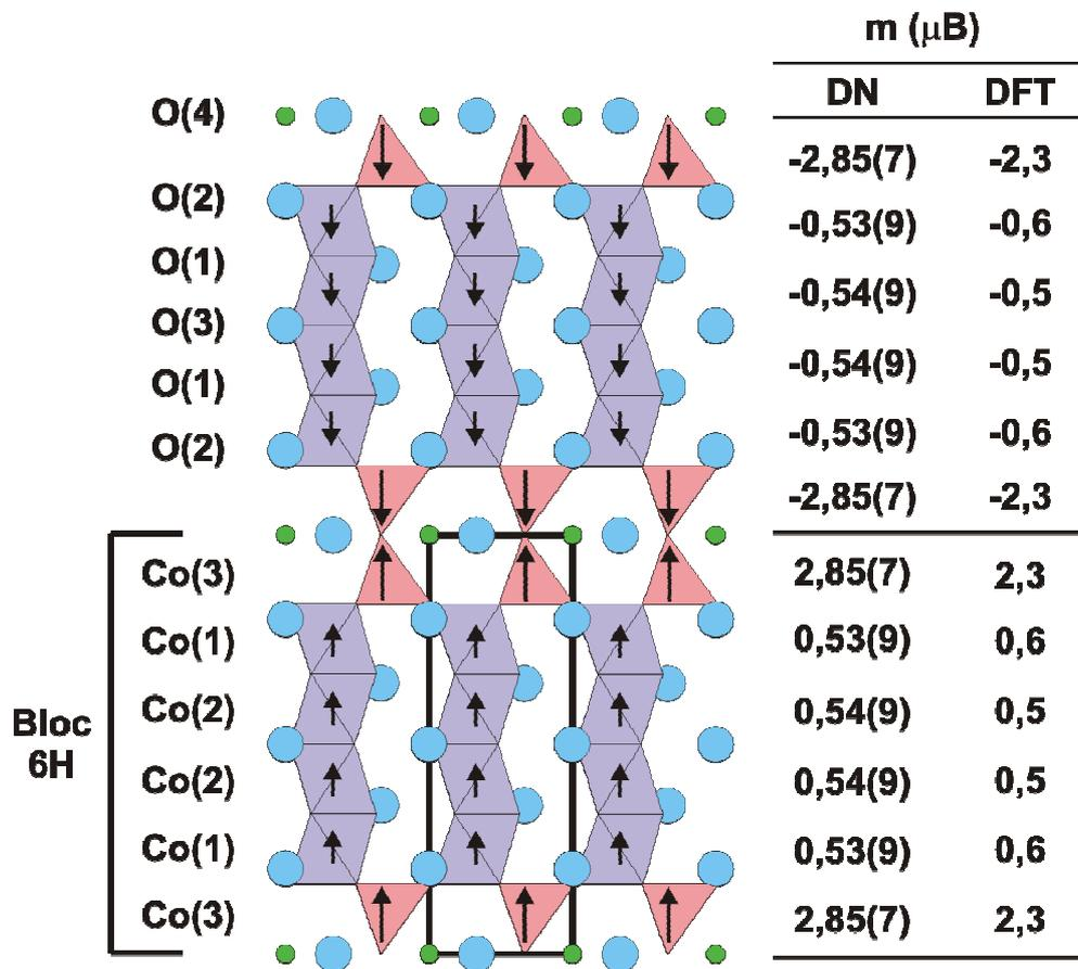
Figure 3.4 : Représentation de la structure magnétique à 4 K de  $Ba_6Co_6ClO_{15,5}$ . Le tableau présente les valeurs des moments magnétiques portés par chaque atome de cobalt déterminées à partir des données de diffraction des neutrons (DN) et par calculs DFT
