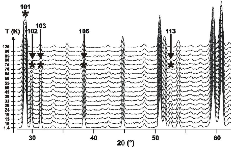
Figure 3.16 : Thermodiffractogrammes de neutrons du composé  $Ba_7Co_6BrO_{16,5}$
