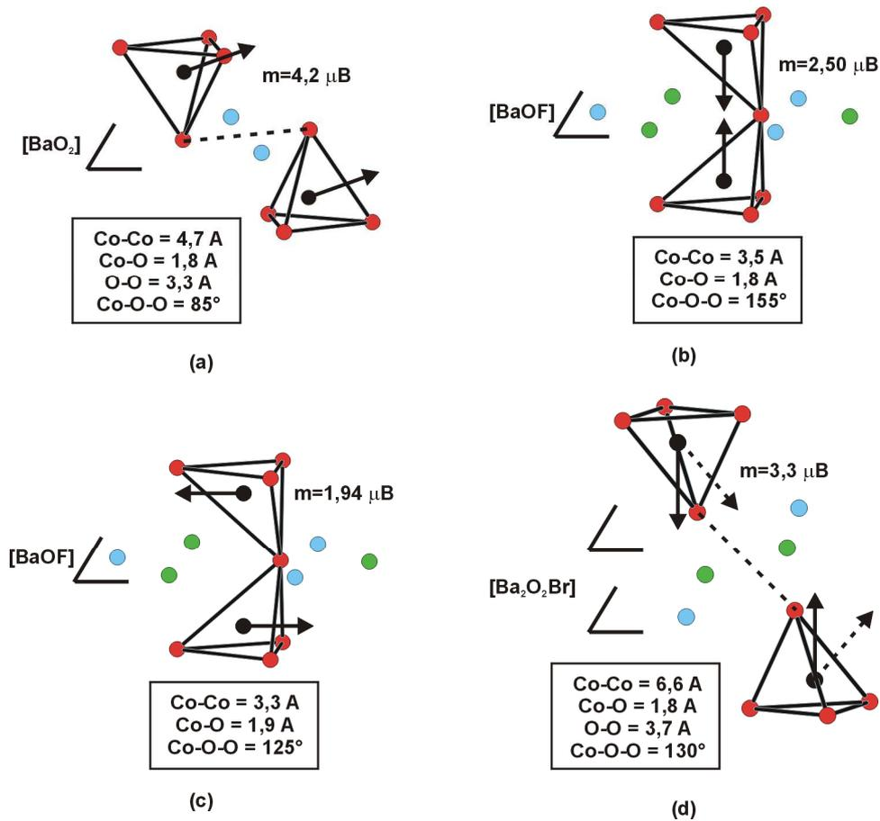
**Figure 4.5 :** Paramètres géométriques, orientation et valeur des moments des interfaces inter-blocs dans (a) les chloro-cobaltites et  $Ba_6Co_6FO_{15,\delta}$  (b)  $Ba_5Co_5FO_{13}$  et (c) les cobaltites  $BaCoO_{3,\delta}$  et (d) les bromo-cobaltites
