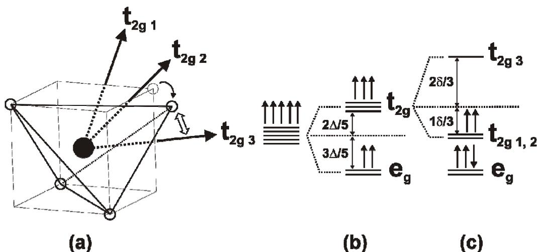
**Figure 4.3 :** (a) orientation des orbitales  $t_{2g}$  d'un atome en environnement tétraédrique, (b) remplissage des cases quantiques en configuration Haut Spin et (c) remplissage des cases quantiques en configuration Spin Intermédiaire
