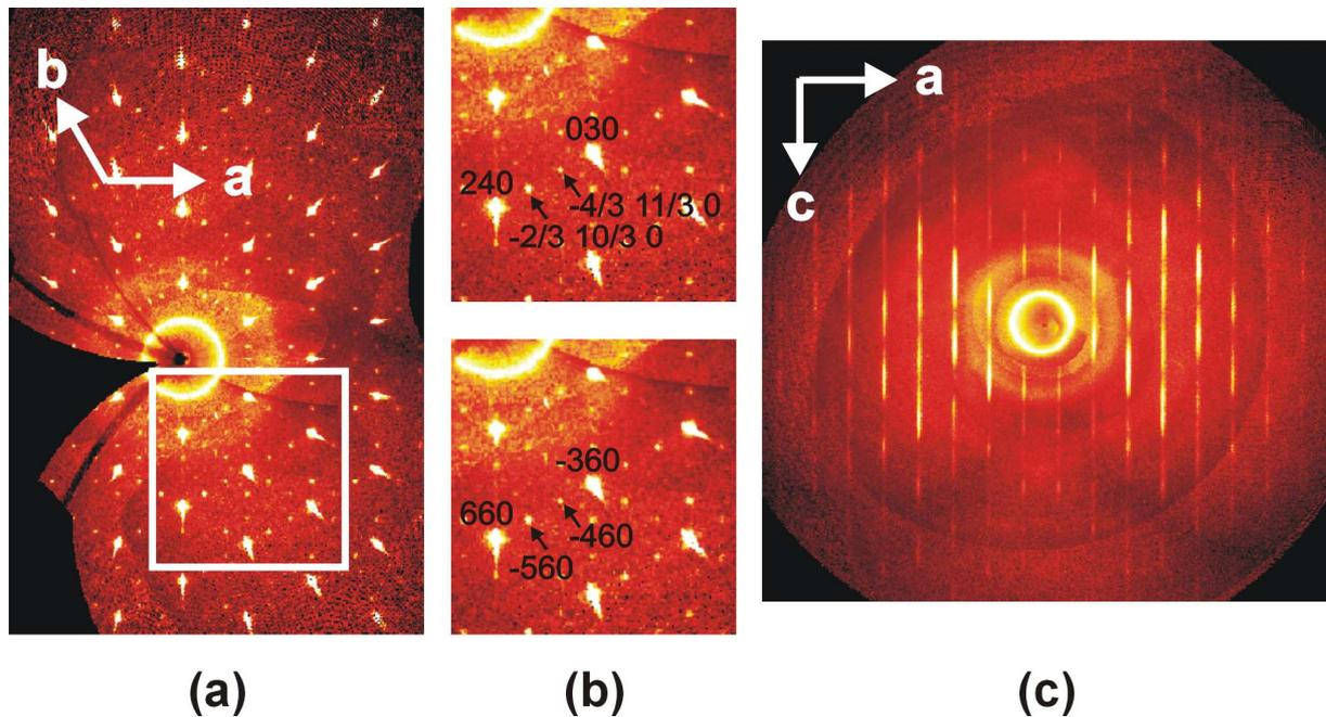
*Figure 2.17 : Strates de précession reconstruites à partir des données collectées par diffraction des rayons X sur un monocristal de  $Ba_7Co_6BrO_{17}$ : (a) strate  $(hk0)$ , (b) zoom sur la strate  $(hk0)$  et (c) strate  $(1/3kl)$*
