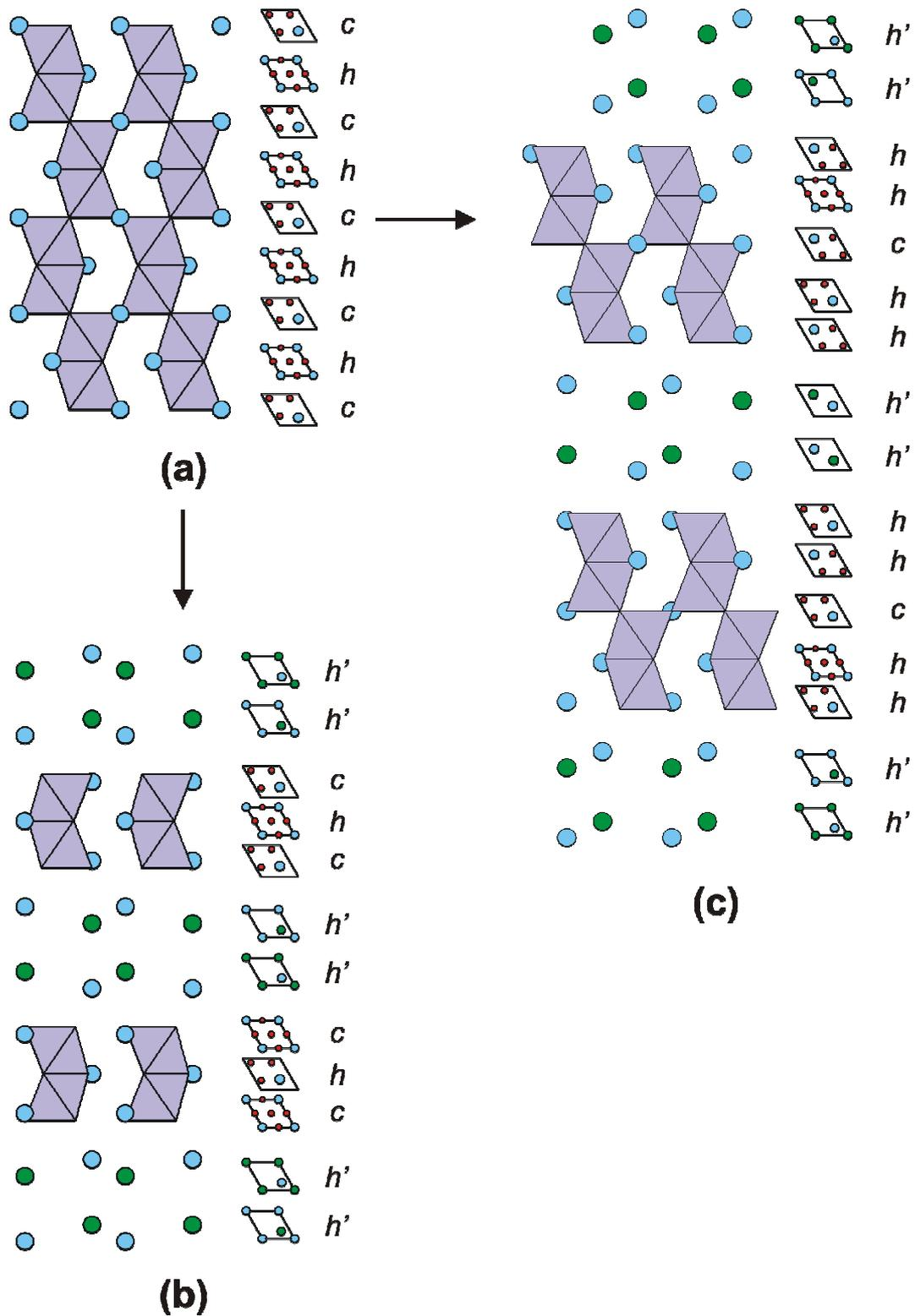
Figure 1.8 : Suppression de la dimensionnalité 3D par insertion de couches [BaCl] dans (a) 4H-BaRuO<sub>3</sub> pour former les composés (b) 10H-Ba<sub>3</sub>Ru<sub>2</sub>Cl<sub>2</sub>O<sub>9</sub> et (c) 21R-Ba<sub>7</sub>Ru<sub>4</sub>Cl<sub>2</sub>O<sub>15</sub>
