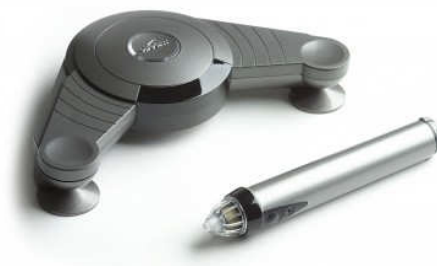
Dispositif de transformation d'un tableau existant
