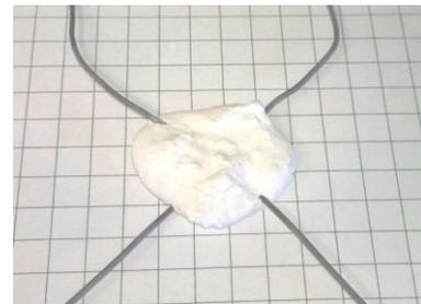
Fig.14. Echantillon permettant de tester l'influence du ciment d'enrobage que les propriétés de l'isolation inter-spaires.
