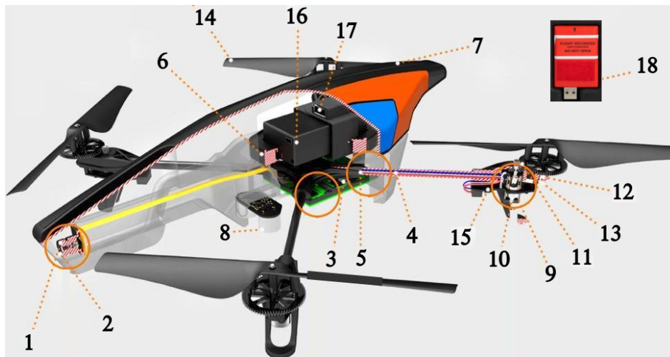
Figura 2.2: Esquema del ARDrone 2.0, complementario al Cuadro 2.1. En el cual, se indican cada una de las partes de la plataforma robótica
