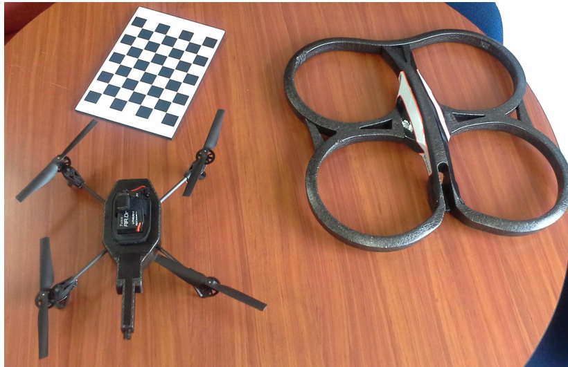
Figura 4.2: Escenario para la captura de imágenes y elementos empleados para la etapa de calibración.
