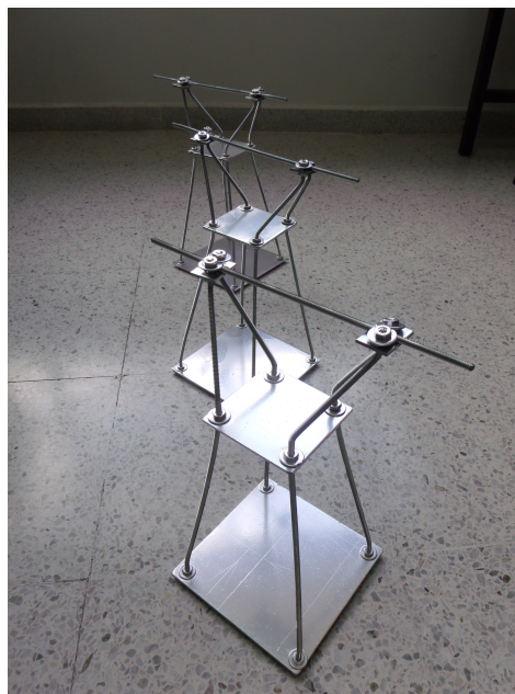
Figura 4.8: Torres construidas para emular líneas de transmisión en la maqueta.
