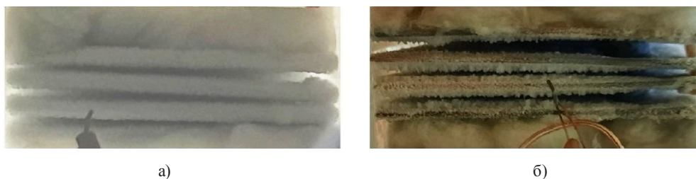
Рис. 8. Образование инея на ребрах со стороны входного (а) и выходного (б) сечений
