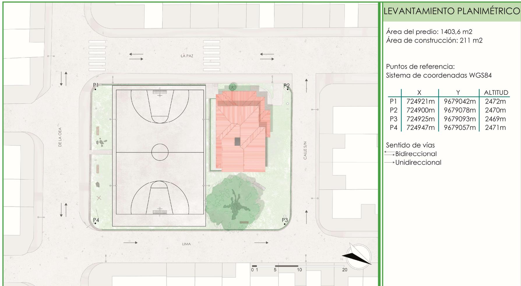
Figura 42. Levantamiento planimétrico del parque Antártico. **Elaboración:** Propia.
