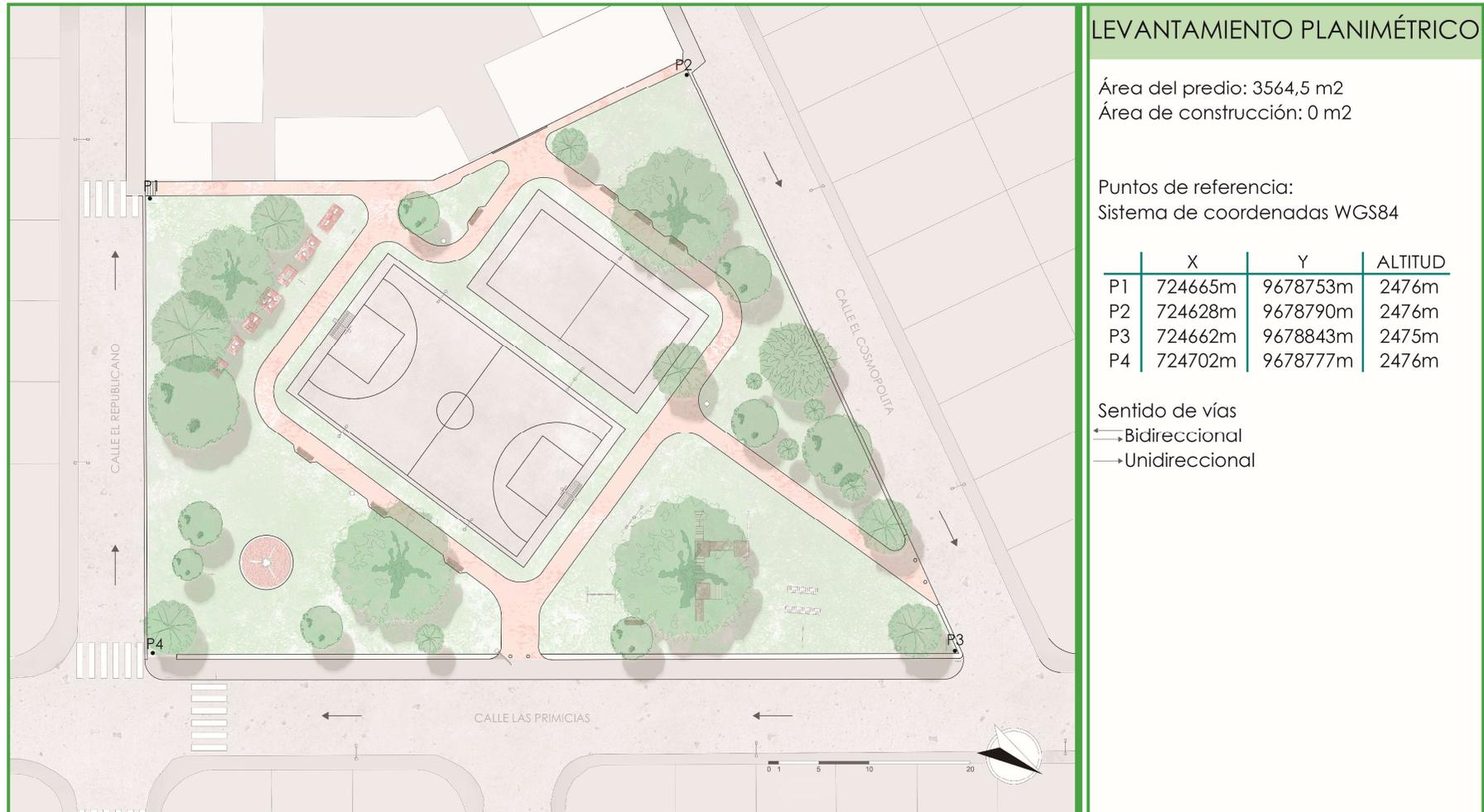
Figura 23. Levantamiento planimétrico del parque "El Edén". **Elaboración:** Propia.
