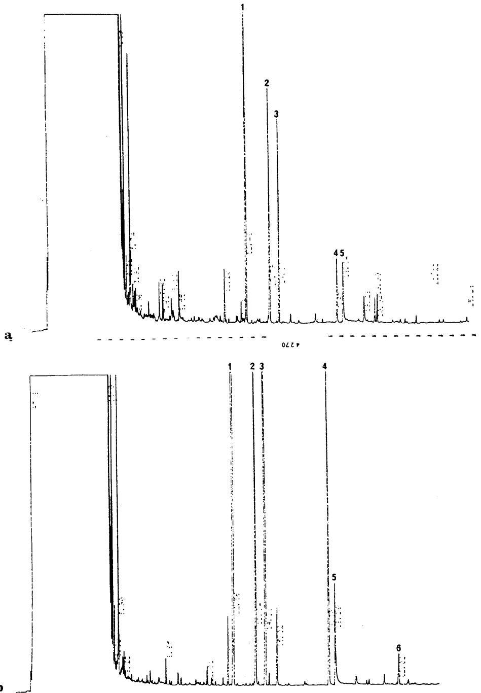
FIGUUR 4.8 Gaschromatogramuitdrukke van die geurprofiel van Tylosema esculentum -blomme in 'n bak met slegs 1.5% agarmedium (a) en blomme in 1.5% agarmedium plus 5% glukose (b). Vergelyk pieke 1, 3 en 4 van die uitdrukke.
