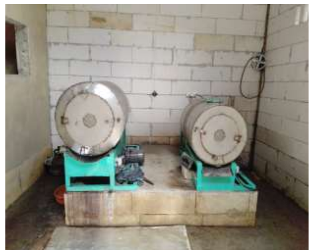
Gambar 4. Tungku memproses Teh Hijau dengan kompor gas
