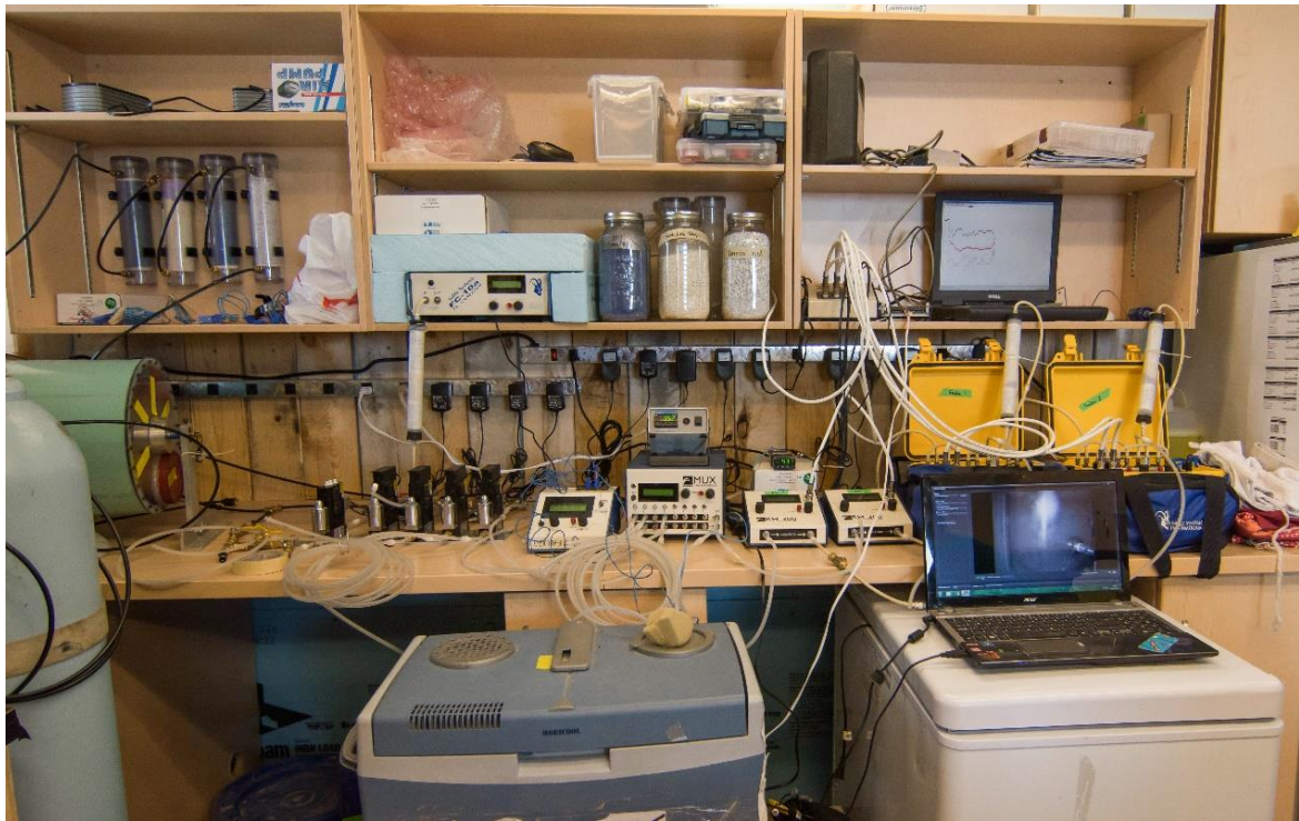
Figure I.10 Système de respirométrie utilisé à Alert pour mesurer la performance métabolique ( M_{\text{sum}} et BMR) des plectrophanes des neiges. © Audrey Le Pogam
