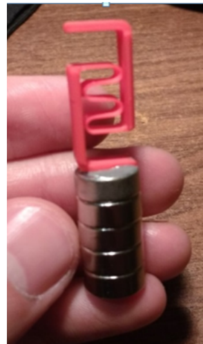
Figura 5.9: Se observan las dimensiones geométricas del segundo diseño de resorte impreso en su posición extendida. A la derecha se muestra el resorte fabricado.
