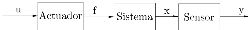
Figura 3.1: Diagrama a lazo abierto de un sistema mecánico flexible, donde se presenta un actuador, el sistema mecánico, y un sensor. u es la entrada al actuador, f es la fuerza que afecta al sistema, x es la salida del mismo e y es la salida medida con un sensor.
