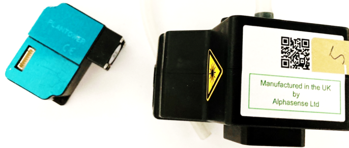
Abbildung 21: Plantower PMS3003 Sensor (links) sowie Alphasense OPC-N3 Sensor (rechts)
