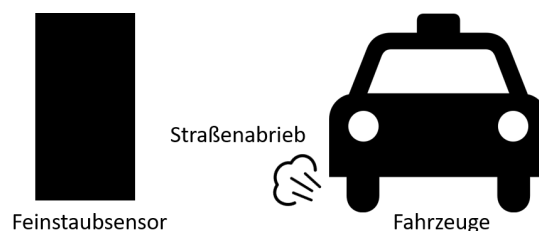
Abbildung 11: Schematische Darstellung der mobilen Verkehrszählung mit Feinstaubsensoren in FCO-Anwendungen
