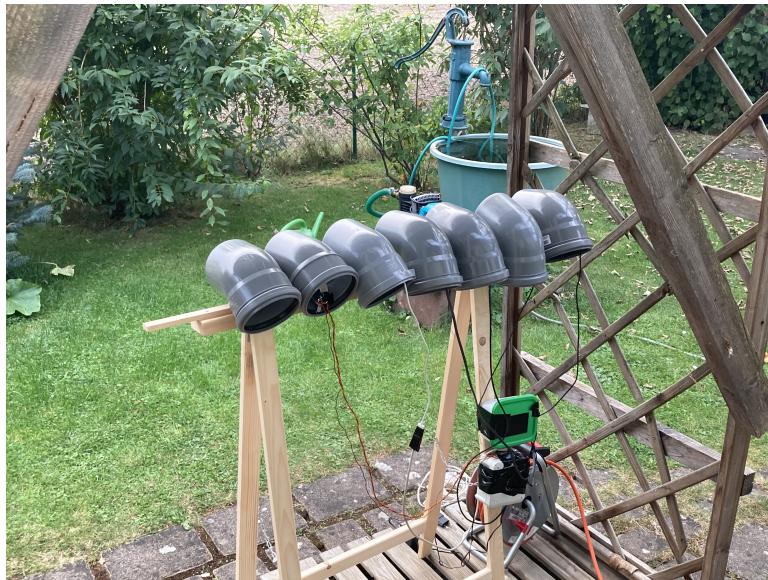
Abbildung 25: Vergleichsmessung von fünf OPC-N 3 sowie einem PMS 3003 Feinstaubsensor
