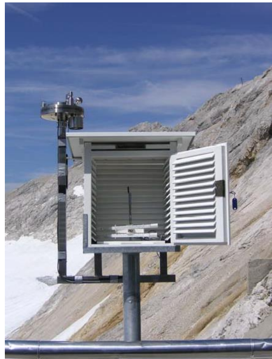
Abb.1: Automatische Wetterstation und konventionelle Wetterhütte am Schneefernerhaus zur vergleichenden Messung der täglichen Extremtemperaturen
