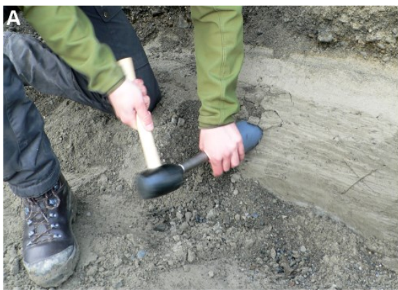
Figur 17 A, B. All provtagning och analys för luminiscensdatering måste utföras utan att provet utsätts för ljus och därmed nollställs och ger felaktigt resultat. Prover tas därför i ljustäta stål- eller PVC-rör som hamras in i sedimenten (A), eller nattetid, och i luminiscenslaboratorier används svag röd eller orange belysning (B). Foto: Helena Alexanderson.
