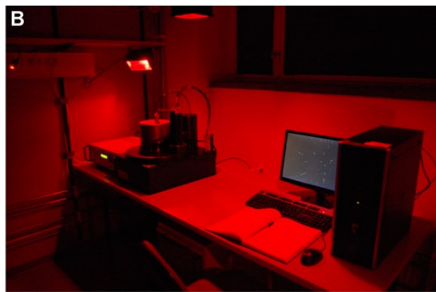
Figur 17 A, B. All provtagning och analys för luminiscensdatering måste utföras utan att provet utsätts för ljus och därmed nollställs och ger felaktigt resultat. Prover tas därför i ljustäta stål- eller PVC-rör som hamras in i sedimenten (A), eller nattetid, och i luminiscenslaboratorier används svag röd eller orange belysning (B). Foto: Helena Alexanderson.
