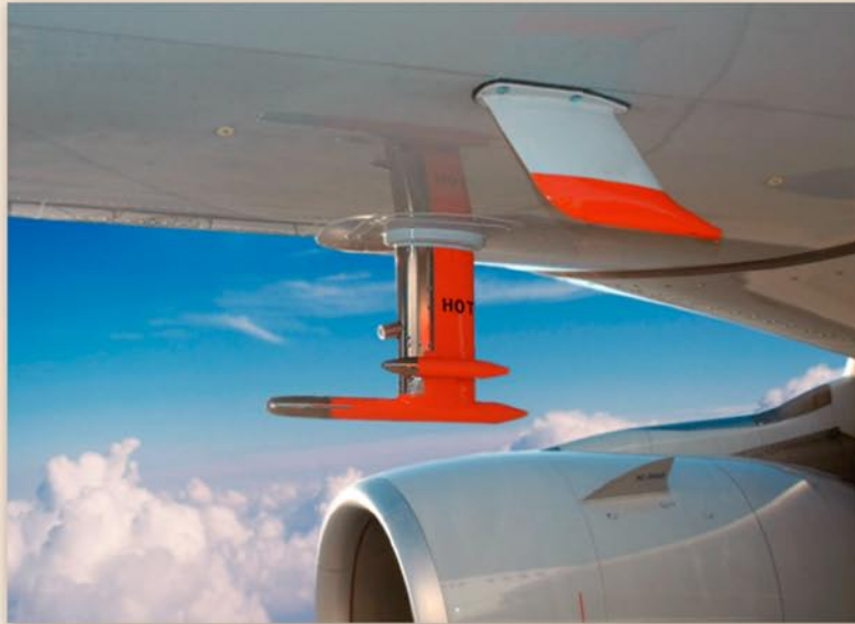
Detalj från den Airbus 340-600 från Lufthansa som används av IAGOS-CARIBIC. I mitten syns intaget för luft och aerosolpartiklar (orange) för atmosfärisk provtagning.
