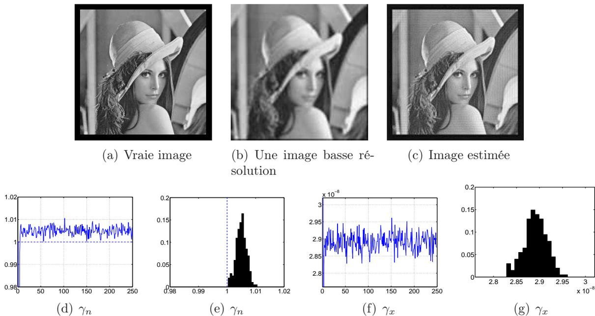
FIGURE 1 – Super-résolution non supervisée. Les figures (a), (b) et (c) sont respectivement la vraie image, une image basse résolution et l'image estimée. Les figures (d) et (e) sont respectivement la chaîne de Markov et l'histogramme de  $\gamma_n$ . La ligne pointillée correspond à la vraie valeur. Les figures (f) et (g) sont respectivement la chaîne de Markov et l'histogramme de  $\gamma_x$ .
