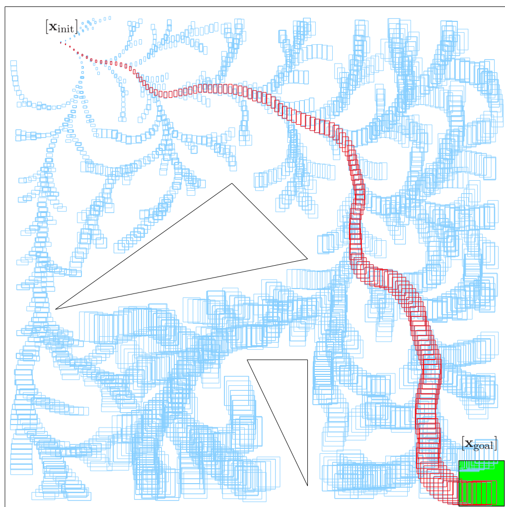
FIG. 7.2 – Trajectoire sûre dans un environnement avec peu d'obstacles et une grande zone d'arrivée
