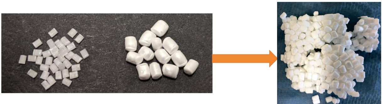
Abbildung 9.5: PLA/1800H 90/10 Partikel. Ungeschäumt, geschäumt und nach dem Formteilprozess.
