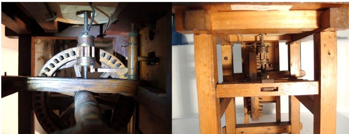
Abbildung 11: Ansicht der Getriebe von zwei verschiedenen Seiten, im rechten Bild oben ist ein aufgeklebtes Papieretikett mit der Inventarnummer des Museums erkennbar. (Fotos: Oliver Zauzig, 2012)
