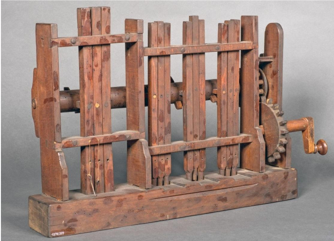
Abbildung 31: Die Pochstempel mit den links im Bild noch erhaltenen Fixierbolzen sind von dieser Seite gut sichtbar. Diese Fixierelemente dienen dazu, gezielt Stempel aus dem Radius der sich drehenden Daumen zu heben und damit auch bei der drehenden Welle still zu halten. (Martin Liebethuth, Göttingen, 2019)
