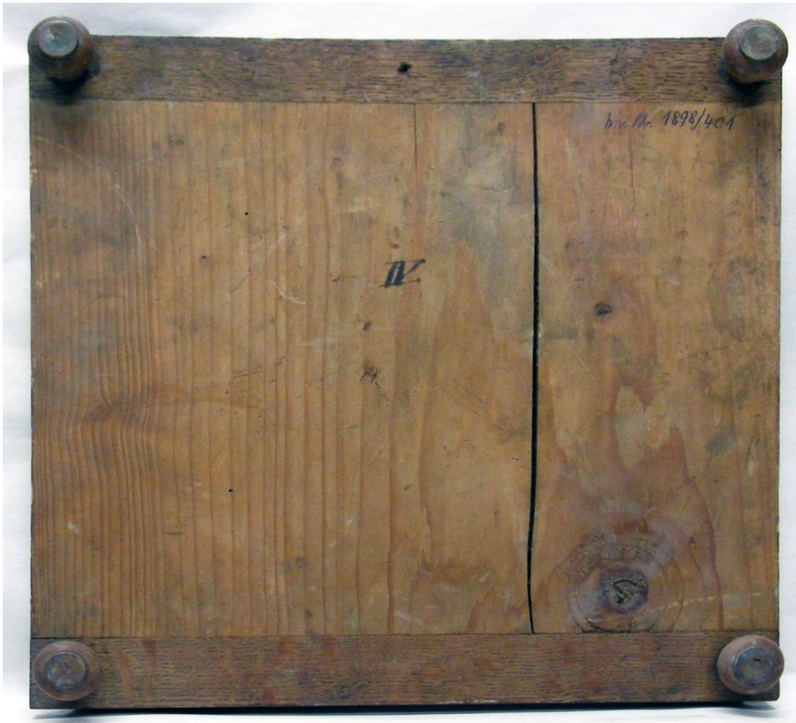
Abbildung 85: Rückseite des Modells mit der im Museum aufgebrauchten römischen Vier und der Inventarnummer 1898/401. Deutlich sichtbar ist der Riss im Holz, der auf der Oberseite jedoch nur im Modellgraben zum Vorschein kommt. Er ist wahrscheinlich ein Hinweis auf zu trockene Umgebungsluft und damit unsachgemäße Lagerung. (Foto: Oliver Zauzig, 2012)
