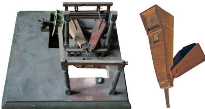
Abbildung 21: Grundplatte des Modells ohne Hochofen, rechts ist einer der beiden Blasebälge zu sehen. (Foto: Oliver Zauzig, 2012)
