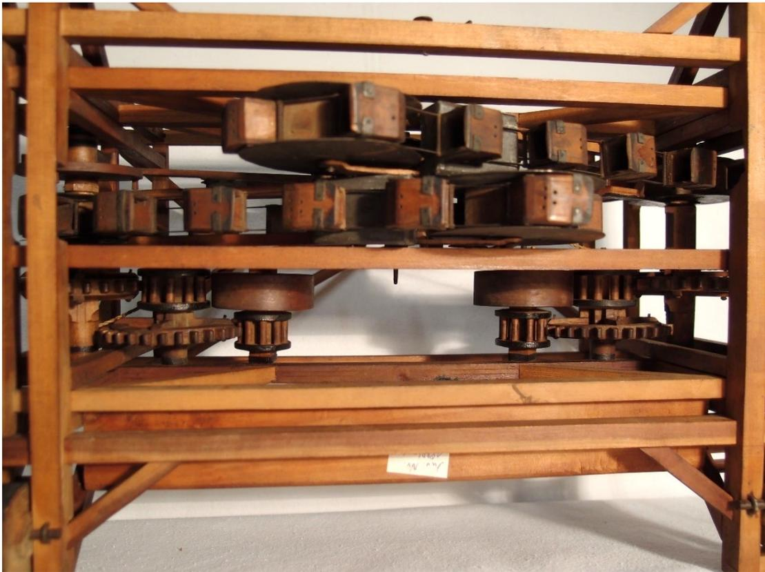
**Abbildung 99:** Blick von unten ins Innere des Modells. Gut sichtbar sind die beiden endlosen Eimerketten bzw. Paternoster (oben) und die beiden Getriebe (unten) sowie die Aufhängung für zwei der vier Walzenräder (links und rechts unten). (Foto: Oliver Zauzig, 2014)
