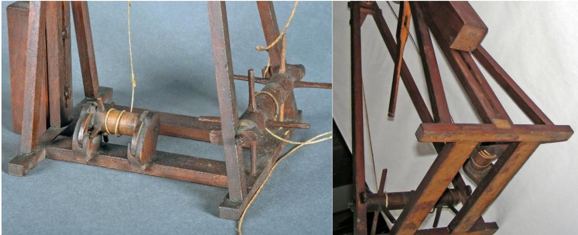
**Abbildung 26:** Im linken Bild sind die beiden Seiltrommeln sichtbar. Im rechten Bild ist das Papieretikett zu erkennen, das noch aus der Zeit der Nutzung zu Lehrzwecken stammt. Es kommt nur durch Anheben des Rammbären zum Vorschein. (Foto: Martin Liebetruh, Göttingen, 2019)
