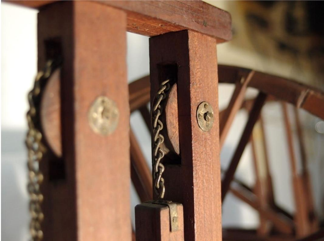
**Abbildung 108:** Der niedergedrückte Kolben hebt durch eine Kette über die Umlenkrolle den anderen Kolben. Auch durch diese Bewegung wird sichtbar, dass es sich bei dem Modell nicht um ein Pochwerk handeln kann. (Foto: Oliver Zauzig, 2014)
