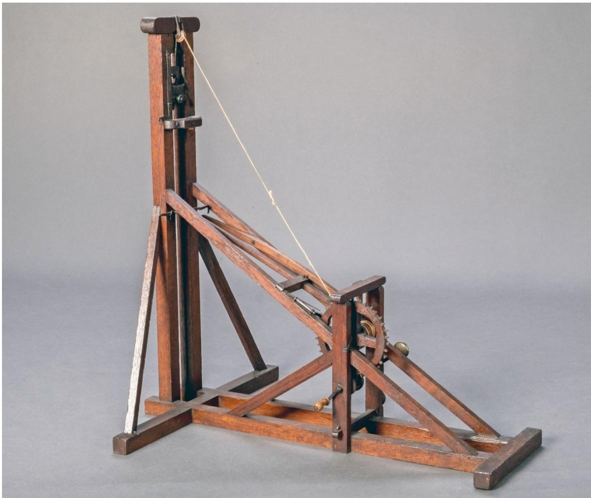
**Abbildung 40: Modell einer Ramme mit spezieller Greifzangenkonstruktion und Seiltrommel (Haspel)**
