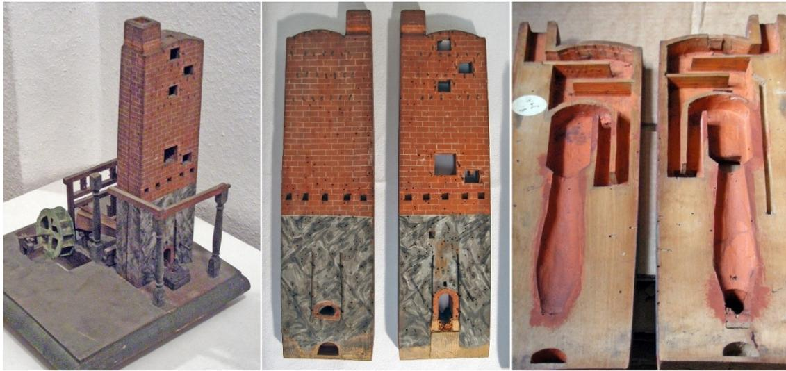
Abbildung 20: Modell des zerlegbaren Hochofens mit Blasebälgen und Wasserrad, rechts ist das Innere des Ofen sichtbar. (Fotos: Oliver Zauzig, 2012)
