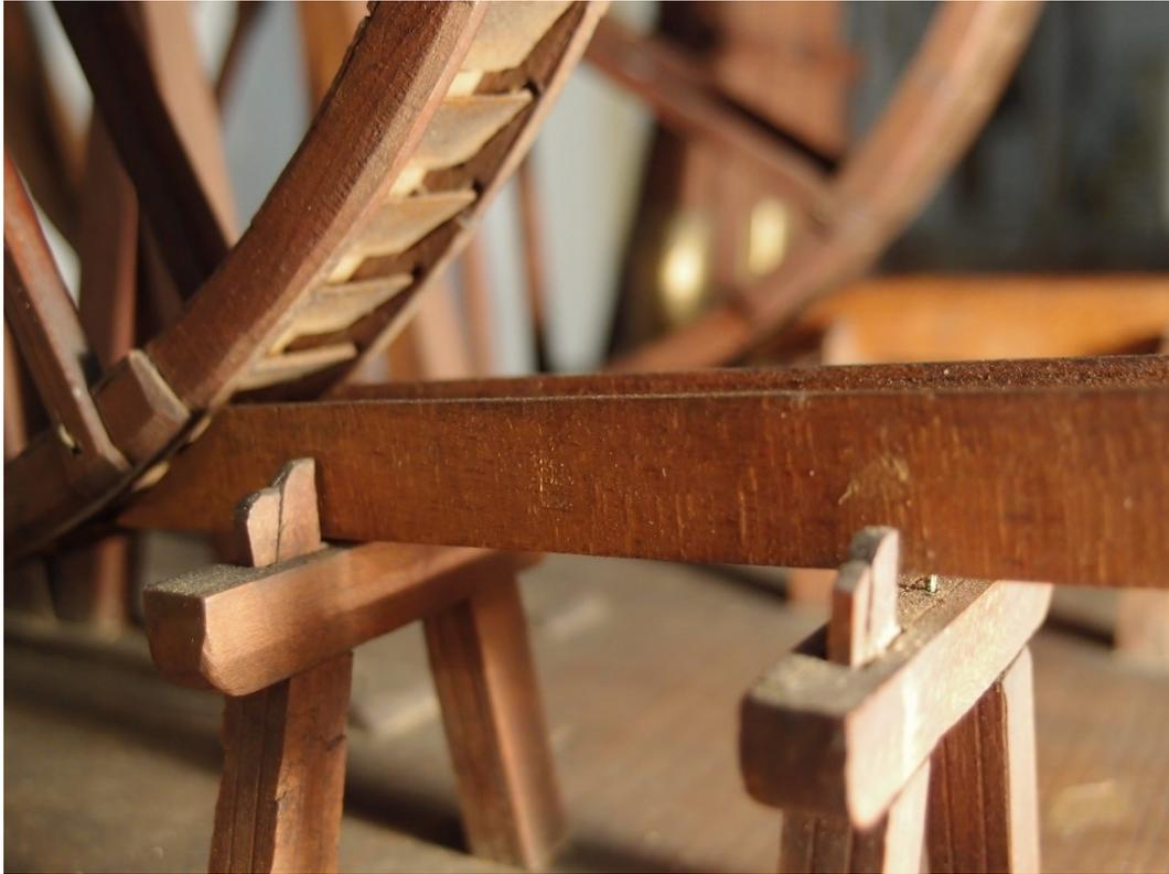
**Abbildung 106:** Im Bild gut sichtbar sind die Zuführeinrichtung für das Wasser (Gerinne) und die Form des mittelschlächting arbeitenden Wasserrades als Zellenrad. Die hier zu erkennende Neigung des Gerinnes ist auf den leicht reparaturbedürftigen Zustand des Modells zurückzuführen. (Foto: Oliver Zauzig, 2014)
