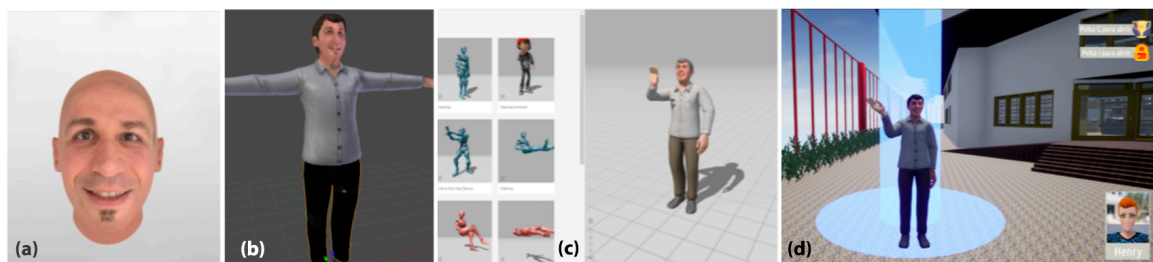
Figura 3: Proceso de generación de personajes 3D partiendo de la cabeza escaneada con Game Avatar (a), para incorporarle un cuerpo usando la herramienta Blender (b) añadirle animaciones con Adobe Fuse (c), y finalmente integrarlo en el videojuego (d).
