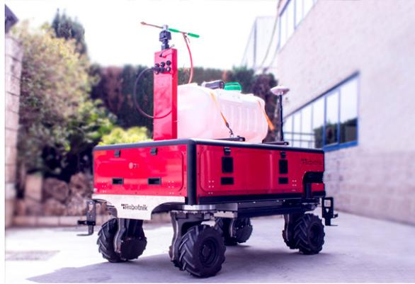
Figura 2.4: Robot móvil customizable RB-VULCANO PRO de Robotnik<sup>5</sup>
