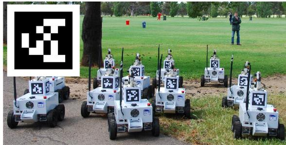
**Figura 3.6:** Ejemplo de uso de los Apriltag para localización e identificación de varios robots<sup>2</sup>
