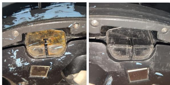
(a) Sensor estropeado      (b) Sensor funcional
