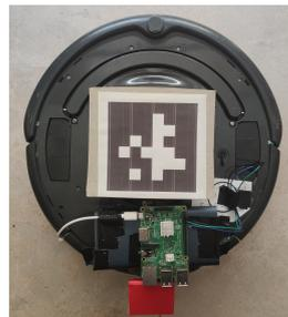
**Figura 3.7:** Robot con el Apriltag colocado para su localización
