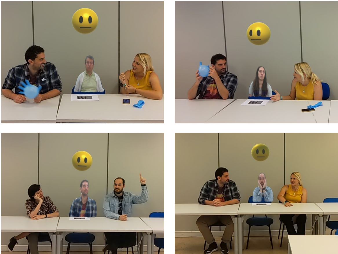
Figura 6.3: Ejemplos de correctos resultados de clasificación de la categoría Neutral y segmentación de la persona proyectada en la aplicación implementada en HoloLens 2
