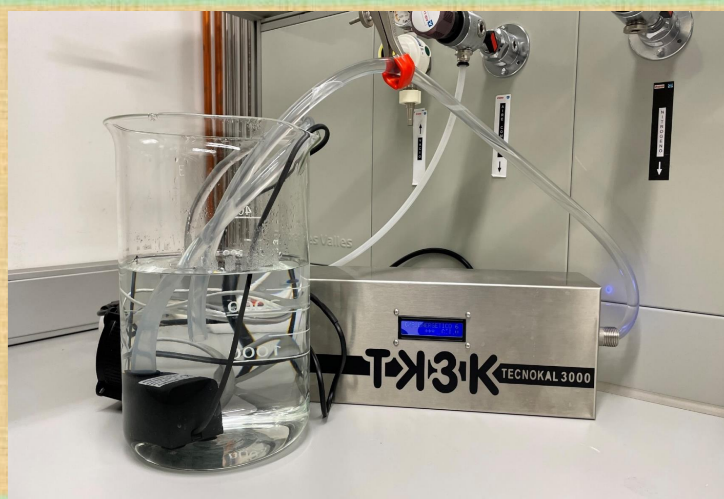
Figura 2. Montaje experimental para recircular el agua con y sin el equipo en funcionamiento
