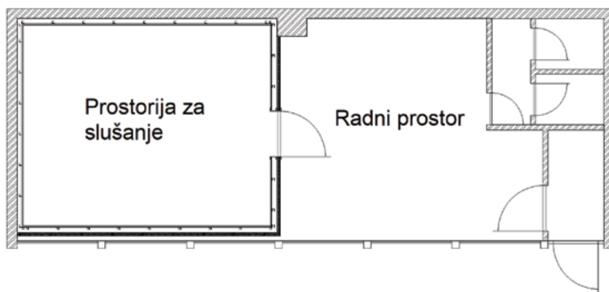
Slika 2: Tlocrt Auralizacijskog laboratorija - prostorija za slušanje u lijevom dijelu izgrađena je po principu “kutija u kutiji”
