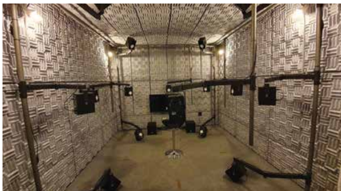
Slika 4: Unutrašnjost prostorije za slušna ispitivanja Auralizacijskog laboratorija
